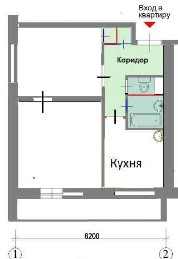
Рисунок 7.17 – Перепланировка в крупноблочном МКД с расширением санузла
