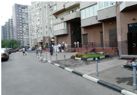
Разделение тротуара и проезжей части дорожным бордюром и столбиками
