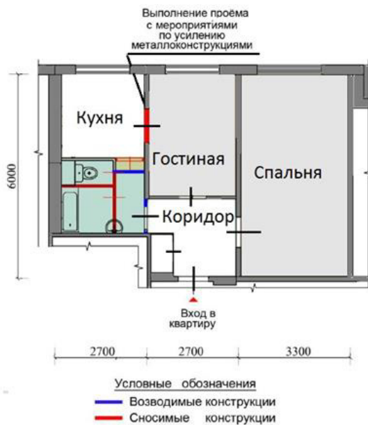
Рисунок 7.16 – Варианты перепланировки в панельном доме с увеличением площади санузла и выполнением проема в несущей стене из гостиной на кухню с усилением металлоконструкциями
