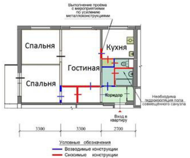
Рисунок 7.16 – Варианты перепланировки в панельном доме с увеличением площади санузла и выполнением проема в несущей стене из гостиной на кухню с усилением металлоконструкциями
