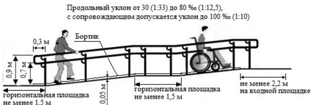
Рисунок 3.20 – Схема пандуса перед входом в здание
