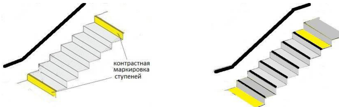
Рисунок 8.3 – Ошибки при контрастной маркировке ступеней
