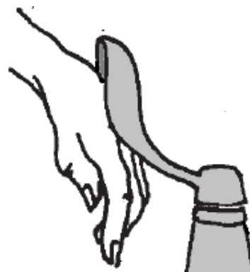
Рисунок 9.11 – Водопроводный кран для инвалидов с парализованными пальцами
