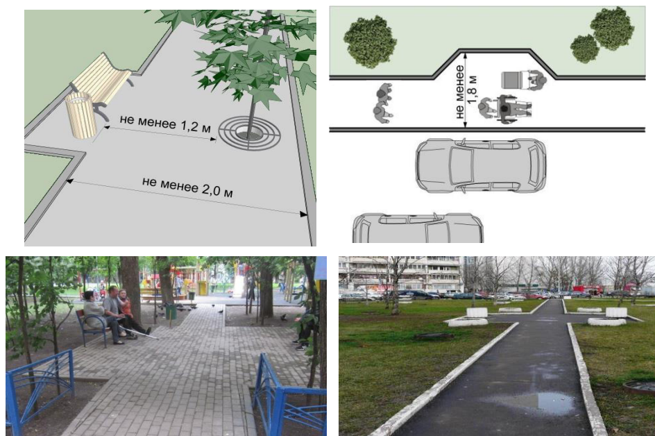
Рисунок 2.2 – Примеры обустройства узких тротуаров
