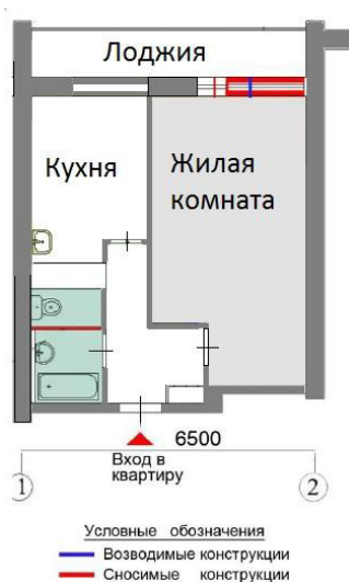
Рисунок 7.17 – Перепланировка в крупноблочном МКД с расширением санузла
