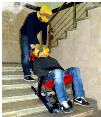
Рисунок 4.24 – Применение эвакуационного стула для спасения инвалидов при отключении подъемных платформ
