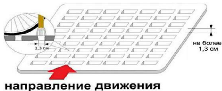
Рисунок 3.32 – Размер ячеек водосборных решеток
