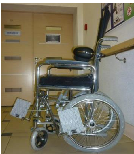
Коляска более узкая чем обычная, на 20 см за счет того, что колеса заведены под сиденье
