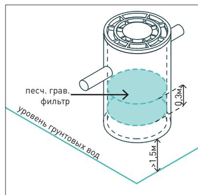
Дренажный колодец применяется на территориях, не оснащенных ливневой канализацией. Оборудуется песчано-гравийным фильтром толщиной 0,3 м (размещается выше уровня грунтовых вод  $\geq 1,5$  м).
