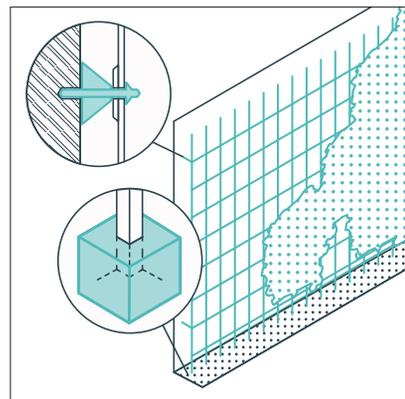
Установка креплений и опорных конструкций вертикального озеленения должна быть надежной, с доступом для ухода по всей высоте конструкции.
