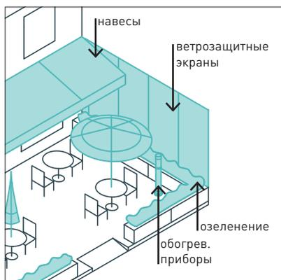
Для обеспечения комфорта в разных погодных условиях применяются навесы, обогревательные приборы, элементы адиабатического охлаждения, ветрозащитные экраны.
