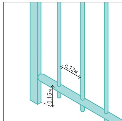
Стойки ограждения — вертикальные, шаг элементов заполнения секций  $\leq 0,12$  м. Расстояние от нижней продольной перекладины до земли  $\leq 0,15$  м.
