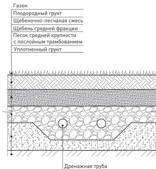
17 Схема устройства основания под отсыпку песком / мульчу с дренажным слоем
