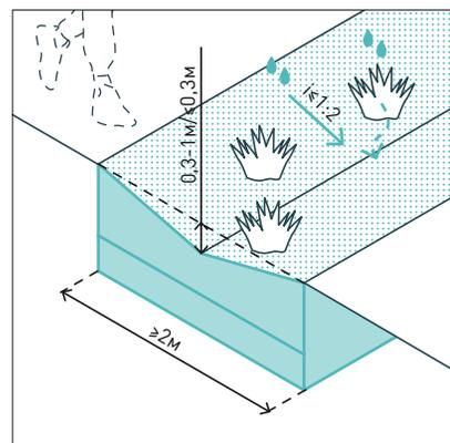
Размеры биодренажных каналов: ширина  $\geq 2$  м, глубина — 0,3–1 м; дождевые сады — разной ширины, глубиной  $\leq 0,3$  м для безопасности падения. Уклон  $\leq 1:2$ .
