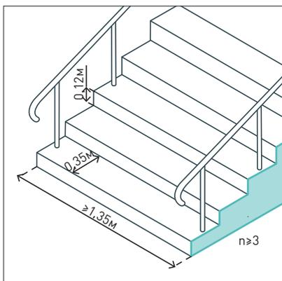
Ширина марша  $\geq 1,35$  м. Высота подступенка — 0,12 м, ширина проступи  $\geq 0,35$  м (в сложившейся застройке высота подступенка  $\leq 0,15$  м, ширина проступи  $\geq 0,30$  м).
