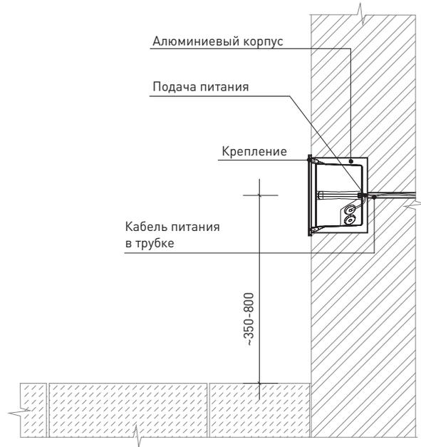
99 Схема установки встроенного светильника
