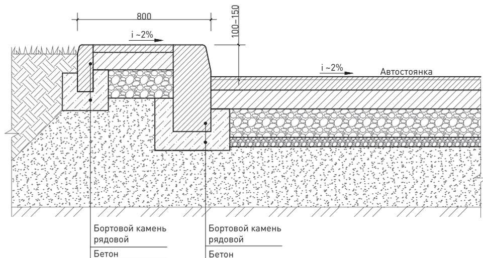
42 Схема въезда в дворовую зону с устройством
