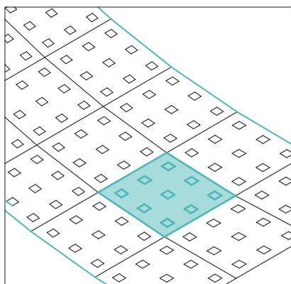
Необходимо применять указатели следующих типоразмеров:  $0,3 \times 0,3$  и  $0,2 \times 0,2$  м, обеспечивая возможность укладки вдоль закруглений.
