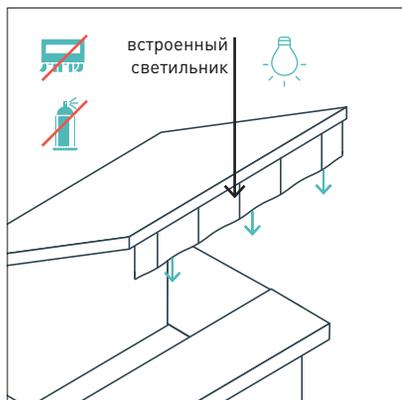
Для безопасности пользователей элементы должны быть освещены с помощью встроенных светильников либо размещаться в хорошо освещенной зоне. Не следует использовать много цветов и активную рекламу.
