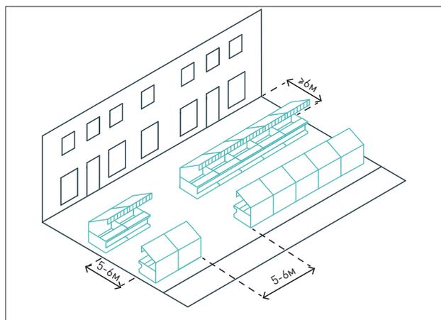
Рекомендуемое расстояние между торговыми рядами — 5–6 м. На площадях следует предусмотреть свободное пространство  $\geq 5-6$  м до фасада для проезда пожарной техники, машин доставки и пр. Ярмарочные стенды группируют до 5 единиц. Необходимо предусмотреть размещение контейнеров для ТБО и возможность подключения к электросетям.
