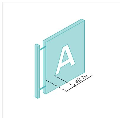
Отступы от границ панель-кронштейна, таблички, витрины до информации, расположенной на элементе —  $\leq 0,1\text{ м}$ ,
