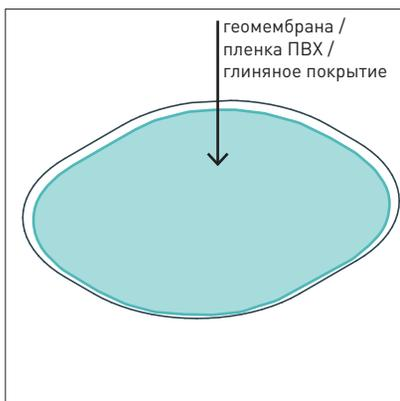
Дно водоемов (прудов, карьеров, ручьев) рекомендуется укреплять водонепроницаемыми геомембранами, пленками ПВХ или глиняным покрытием.
