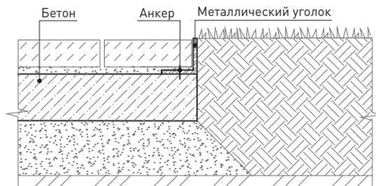
25 Схема устройства сопряжения покрытий при помощи алюминиевого гибкого борта
