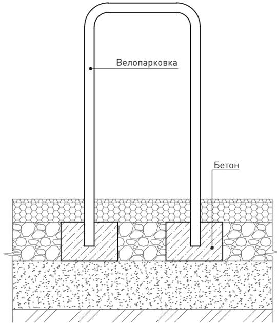
75 Схема установки велопарковки в твердое покрытие
