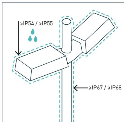
Класс защиты от пыли и влаги для светильников: под навесом — IP54 и выше, открытых — IP55 и выше, в покрытии — IP67 и выше, под водой — IP68.
