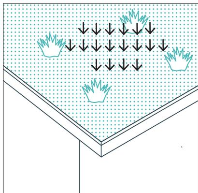
При посадке необходимо предусмотреть равномерное распределение нагрузки на перекрытие кровли для обеспечения целостности конструкции.
