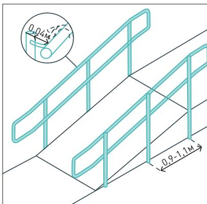
Поручни монтируются в двух уровнях — 0,7 м и 0,9 м, также возможно проектирование третьего поручня на высоте 0,5 м для детей.
