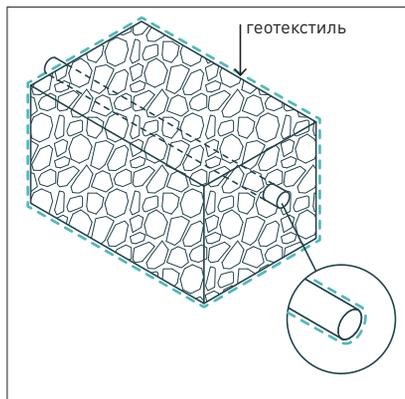
Дренажный слой, дренажную трубу следует оборачивать в геотекстиль для удержания песка и других загрязнений.
