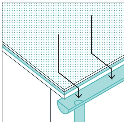
Конструкция кровли должна быть водонепроницаемой, необходимы гидроизоляция над плитой перекрытия и система отвода осадков.
