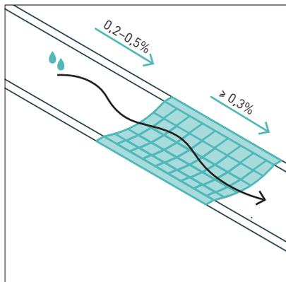
Продольный уклон линейного водоотвода должен обеспечивать быстрый отвод поверхностных стоков (0,2–0,5% — мощеной поверхности, ≥ 0,3% — готовых элементов).
