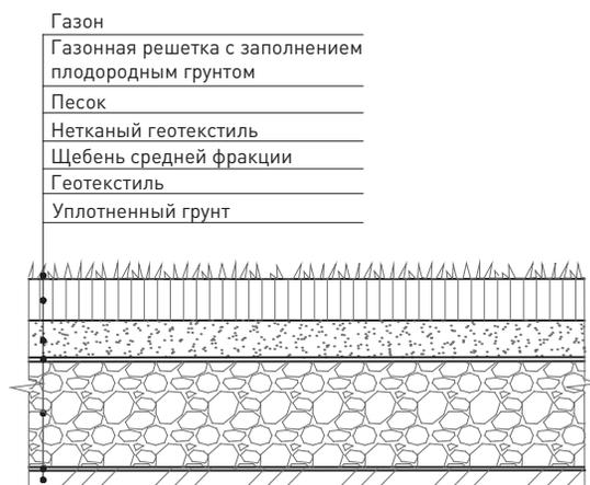
11 Схема устройства основания под экотротуар
