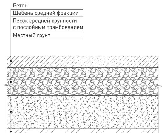
6 Схема устройства основания под асфальтобетон (ЩМА)
