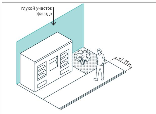
Вендинговые торговые автоматы размещать вблизи крупных ТПУ и входов на станции метрополитена. При размещении на улицах рекомендуется устанавливать автоматы задней стороной к глухому участку фасада. При размещении на улице или парковой дорожке сохранять ширину прохода  $\geq 2,25$  м.
