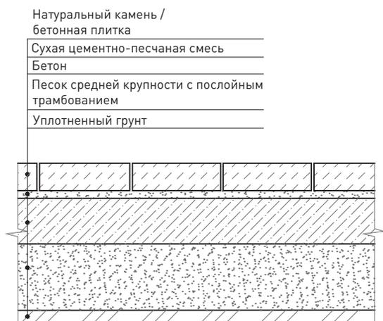
2 Схема устройства основания под бетонную плитку / плитку из натурального камня с армированием (для проезжей части)
