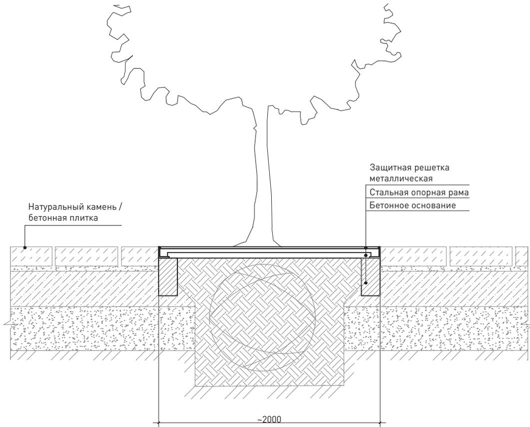
81 Схема устройства проникаемого покрытия для защиты корней от вытаптывания / сечение
