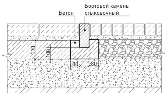
22 Схема устройства сопряжения покрытий при помощи бортового камня рядового стыковочного
