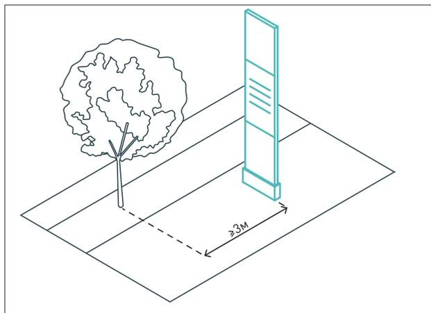
Минимальный отступ от ствола дерева до элемента навигации — 3 м.
