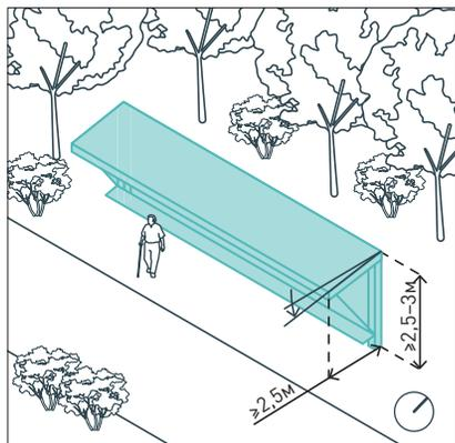
Навес должен иметь наклон к югу и свес на западной и восточной сторонах. Боковые навесы следует выполнять без применения сплошных поверхностей.
