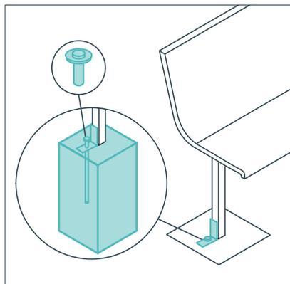
Элементы должны быть прочно прикреплены к фундаментам при помощи бетонирования или анкерного крепления (химические анкеры).
