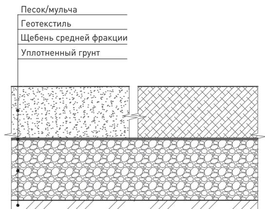
18 Схема устройства основания под резиновую крошку
