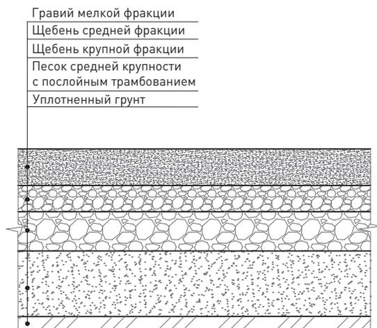
14 Схема устройства основания под покрытие с деревянным спилом / бревном
