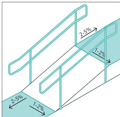
Примыкающие пешеходные пути должны иметь продольный уклон 2–5% в противоположную от пандуса сторону. Поперечный уклон  $\leq 2\%$ .
