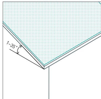
При уклоне кровли 1–35° рекомендуется экстенсивное озеленение (травы, седумы).
