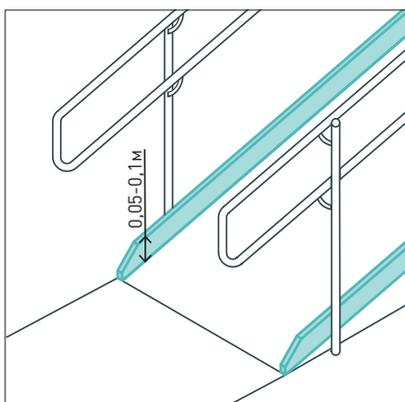
По краям пандуса следует предусматривать защитные колесоотбойники высотой 0,05–0,1 м.
