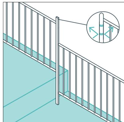
Следует предусмотреть возможность крепления элементов к стойкам на разных уровнях поверхности. Начальные и концевые стойки оснащаются светоотражателями.
