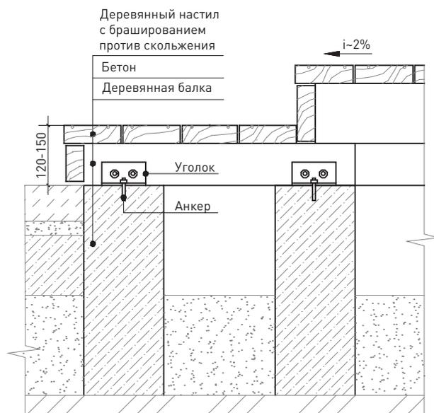
131 Схема устройства деревянного пандуса на сваях на естественном рельефе / сечение
