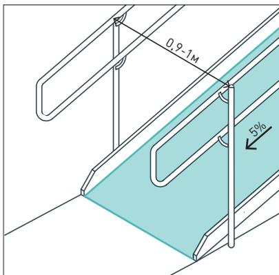
Ширина пандуса  $> 1$  м, расстояние между поручнями — 0,9–1,2 м. Уклон пандуса  $\leq 5\%$  (до 8% у входов в здания, до 10% в стесненных условиях при длине  $\leq 1$  м).
