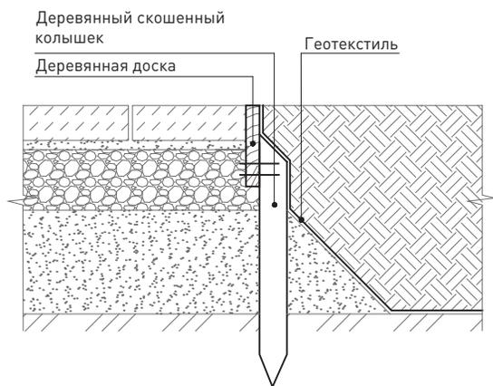
30 Схема устройства сопряжения покрытий при помощи деревянного бордюра с шлицей
