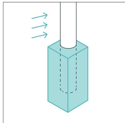
Ограждение должно быть надежно закреплено. Стойки ограждения монтируются на фундамент бетонированием.
