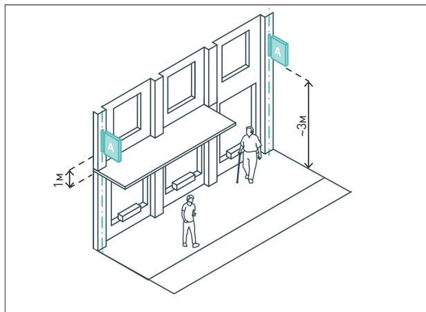
Панель-кронштейны и лайтбоксы следует располагать по центральной оси относительно архитектурных элементов фасада на высоте 3 м (или на 1 м выше козырька). Не рекомендуется размещение панель-кронштейнов на козырьках.
