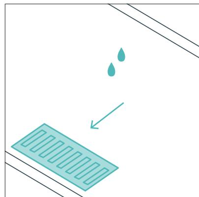
Дождеприемники водоотведения устанавливаются вдоль бортового камня. Пазы дождеприемных решеток перпендикулярны/диагональны движению.
