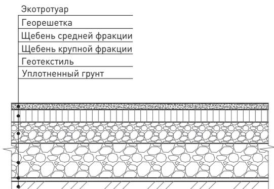
12 Схема устройства основания под настил из древесины
