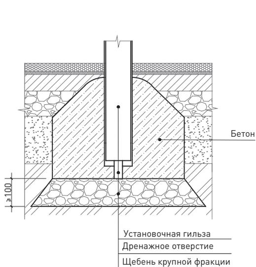
64 Схема монтажа спортивного оборудования в покрытие из насыпного материала
