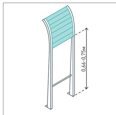
Для возможности прислониться рекомендуется обустройство наклонной поверхности на высоте 0,66–0,75 м.
