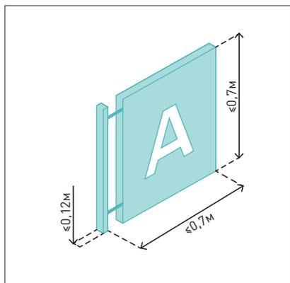
Ширина и высота панель-кронштейна, включая крепления, ≤ 0,7 м. Глубина, включая крепления, ≤ 0,12 м.
