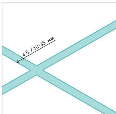
Следует соблюдать цельность покрытия без зазоров. Швы  $\leq 5$  мм — для непроницаемого мощения, 10–35 мм — для проницаемого
