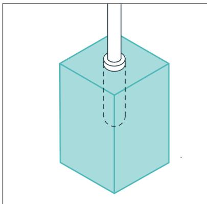
Рекомендуется использование бетонного или чугунного фундамента при установке опор.
