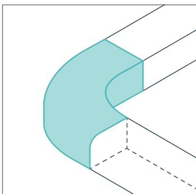
Для обеспечения плавного радиуса скругления целесообразно использование криволинейного бортового камня.
