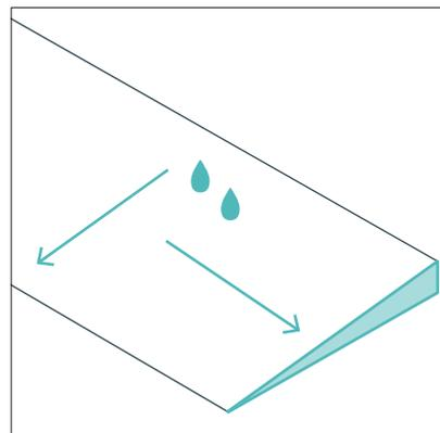
Рекомендуемый поперечный уклон поверхности велодорожки — 1,5–2,5%. Максимальный уклон подъема до 30 м — 7%, 60 м — 6%, 130 м — 5%, 250 м — 4%, 500 м — 3%.
