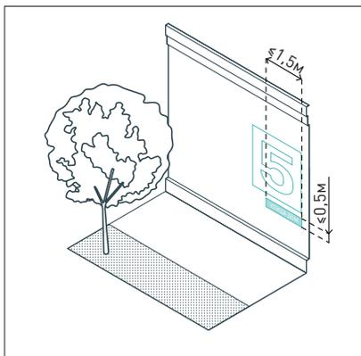
Габариты адресных табличек принимают в зависимости от ширины улицы. Высота таблички  $\leq 0,5$  м, длина  $\leq 1,5$  м.
