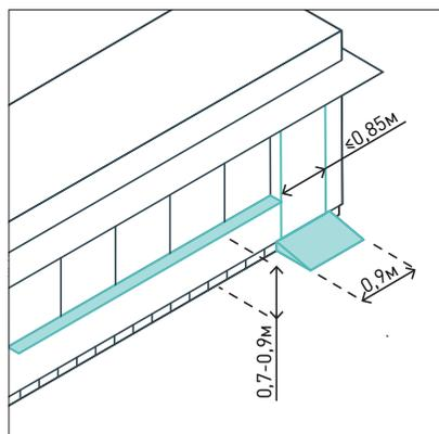
Необходимо обеспечить доступ для МГН при помощи пандуса шириной  $0,9\text{ м}$ . Рекомендуемая высота прилавка —  $0,7-0,9\text{ м}$ . Минимальная ширина дверного проема входа в павильоны —  $0,85\text{ м}$ .
