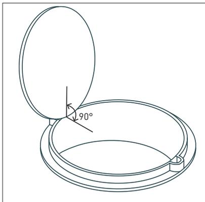
Крышка люка должна оснащаться запорным устройством и обеспечивать фиксацию на 90° при открытии.
