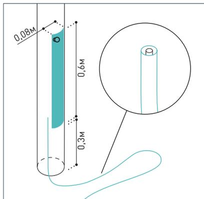
Опоры освещения рекомендуется снабжать нижним кабельным соединением с ревизионным лючком для удобного обслуживания кабелей.
