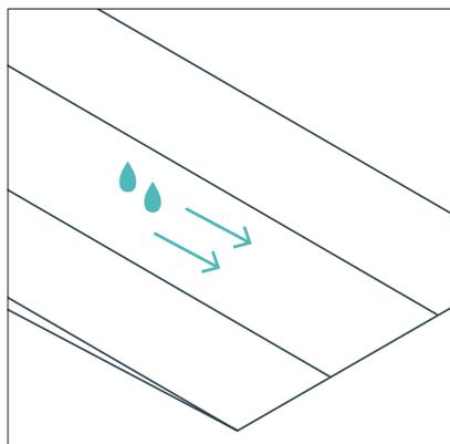
Рекомендуемый поперечный уклон поверхности из асфальто-/цементобетонных покрытий — 1,5%, сборных плитных — 1,5–2%. Максимальный продольный уклон — 5%.
