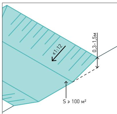
При понижении рельефа рекомендуемый уклон откоса  $\leq 1:12$ . Площадь понижения  $\geq 100$  м<sup>2</sup>, глубина — 0,3–1,5 м. Водосброс осуществляется через перелив, линейный водоотвод и пр.
