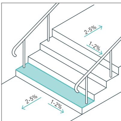
Поперечный уклон ступени — 1–2%. При непроницаемом основании — в сторону нижележащей ступени; при водопроницаемом — в сторону вышележащей ступени. Продольный уклон  $\leq 1\%$ .
