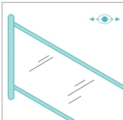
В стесненных условиях следует устанавливать сплошные светопрозрачные ограждения с легкоочищающимся покрытием (из триплекса).
