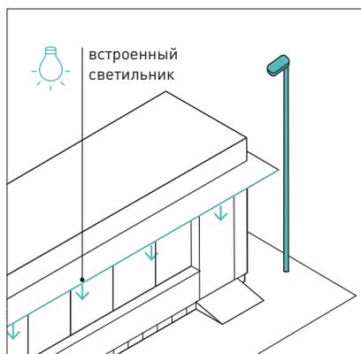
Для обеспечения безопасности элементы должны быть освещены в темное время суток с помощью встроенных либо отдельно стоящих светильников.
