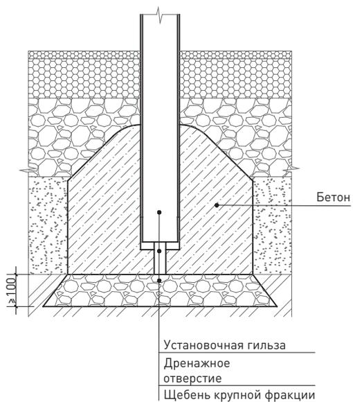
66 Схема монтажа игрового оборудования в покрытие из насыпного материала
