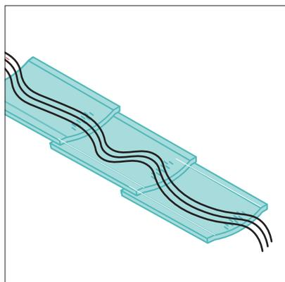
Возможно создание каскадной системы из элементов открытых лотков для обеспечения дополнительной фильтрации водостоков.
