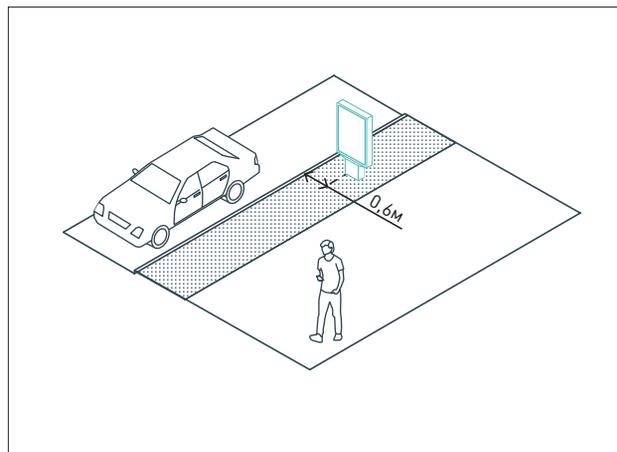
Зона сити-форматов и афишных стендов: места озеленения шириной  $1,5\text{--}3$  м (с отступом  $1,2$  м от края проезжей части) или тротуар шириной  $\geq 2$  м параллельно направлению движения пешеходов. Расстояние  $\geq 2,5$  м от стволов деревьев,  $\geq 0,6$  м от кромок бортовых камней или обочин.
