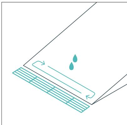
Рекомендуется установка дождеприемников у основания, дополнительных устройств подогрева для защиты от образования наледи.
