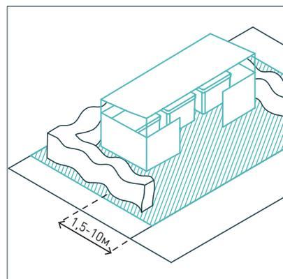
Площадки для сбора мусора рекомендуется размещать вдоль проездов. Расстояние от края проезда до ближайшего мусороприемника — 1,5–10 м. Рекомендуемый уклон поверхности контейнерной площадки — 0,5–2% в сторону проезда. Контейнеры для сбора ТБО следует защитить от попадания осадков.
