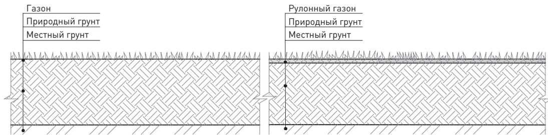
76 Схема устройства газона с дренажем / сечение
