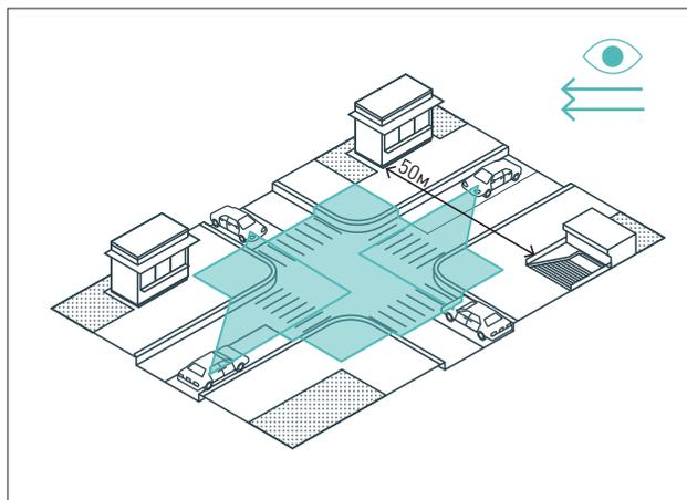
Объекты следует размещать на участках улиц, парков, площадей с высокой пешеходной активностью. При размещении следует обеспечить просматриваемость территорий. В случае расположения на пересечениях путей — обеспечивать треугольник видимости, размер определяется в зависимости от скорости движения пользователей.
