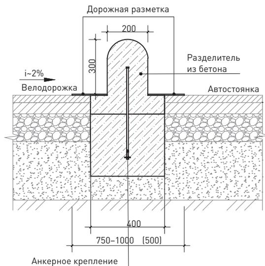
60 Схема установки дорожного разделителя из натурального камня / бетона
