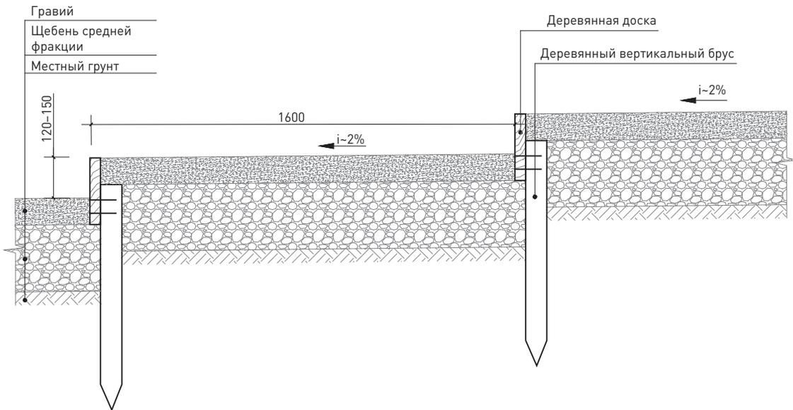
**128** Схема устройства лестницы на естественном рельефе на деревянных столбах / сечение
