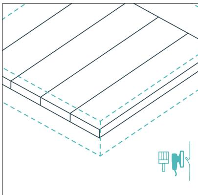
Деревянные покрытия и элементы покрываются защитной пропиткой от гниения, заиливания, шлифуются от острых углов, ям, заноз.
