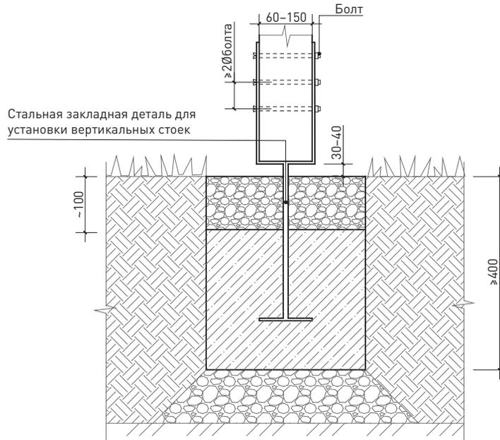
137 Схема установки стойки в твердое покрытие / сечение
