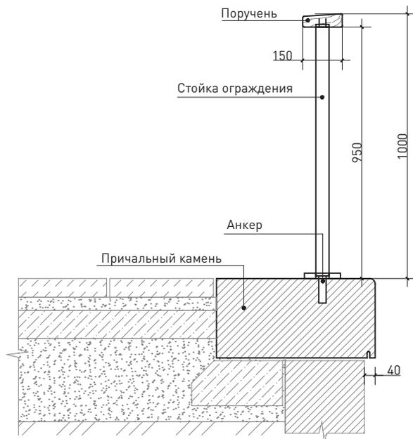
62 Схема установки металлического ограждения с парапетом
