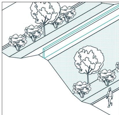
Для защиты от шума предпочтительно использовать элементы озеленения и рельефа, в крайних случаях допускается использовать шумозащитные экраны.
