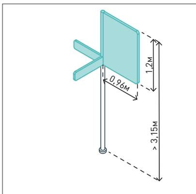
В состав флаговых указателей может включаться рекламный модуль (0,96 × 1,2 м; высота крепления  $\geq$  3,15 м).
