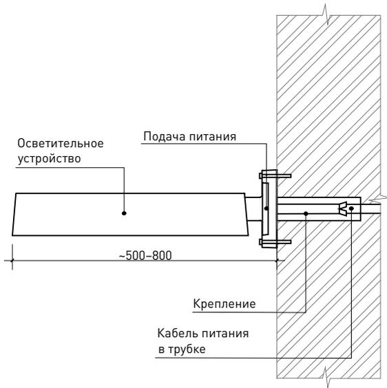
98 Схема установки встроенного светильника
