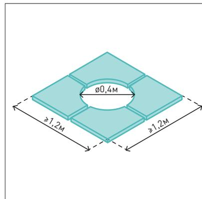
Рекомендуемый размер приствольной решетки  $\geq 1,2 \times 1,2$  м, приствольный диаметр — 0,4 м.
