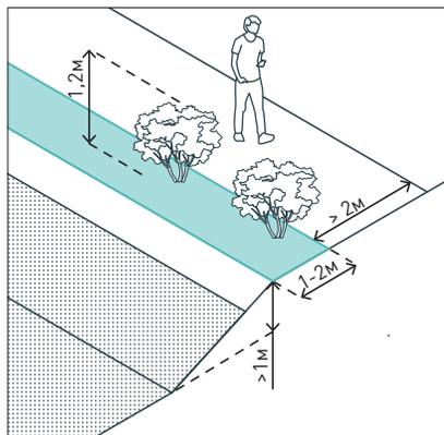
При размещении путей вдоль откосов > 2 м с подпорными стенами > 1 м необходима буферная полоса шириной 1–2 м, плотная посадка кустарников высотой 1,2 м или ограждение.
