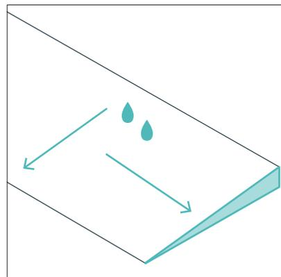
Поперечный уклон поверхности мест пассивного отдыха — 1–2%; спортивных, игровых площадок — 0,5–1% (с покрытием газон — до 5%); теннисного корта — 0,5%.
