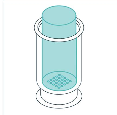
Урны следует оборудовать ведрами с отверстиями для отвода стоков или в виде сетчатой конструкции.
