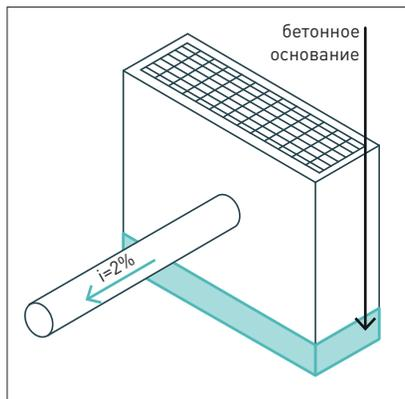
Линейный и точечный водоотвод устанавливается на бетонное основание для надежности монтажа. Уклон присоединения водоотводных труб от дождеприемника — 2%.
