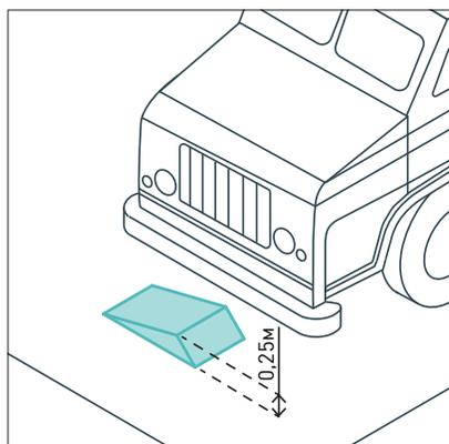
Ограничители въезда, обеспечивающие возможность проезда пожарной техники, должны быть не выше 0,25 м.
