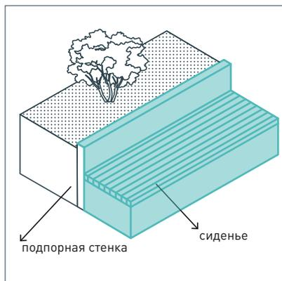
По возможности места для сидения должны быть многофункциональными, служить в качестве ограждения, лестницы, подпорной стенки и т. п.
