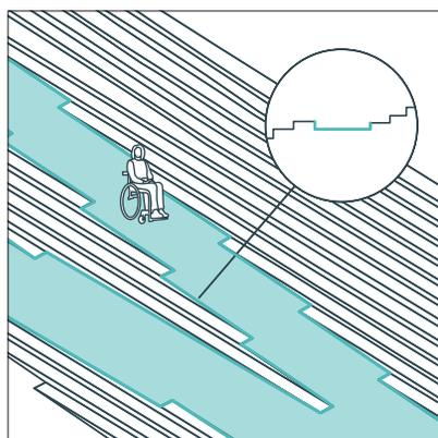
Пандус стрампа должен быть опущен относительно горизонтальной плоскости лестницы для создания колесотбойных бортов, препятствующих скатыванию.
