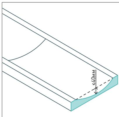
Профиль открытого линейного водоотвода (лотка) должен быть пологим, не глубже 40 мм.
