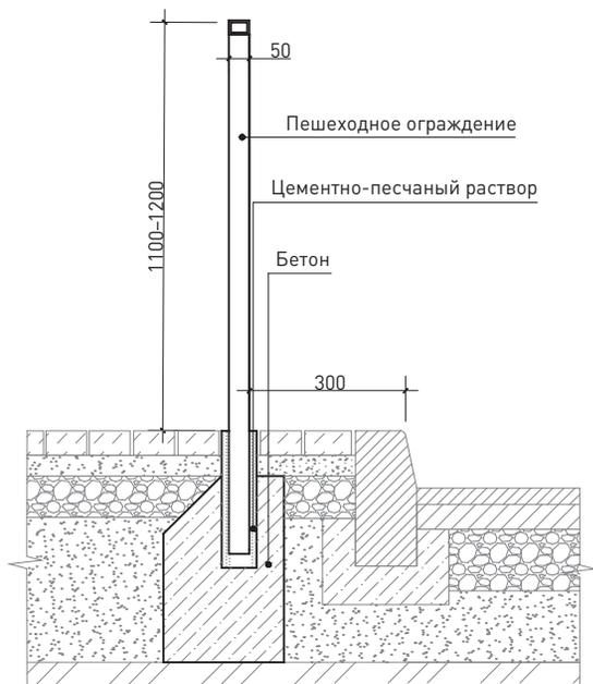
50 Схема установки пешеходного ограждения на островке безопасности
