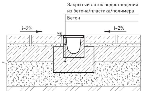
39 Схема устройства щелевого канала водоотведения
