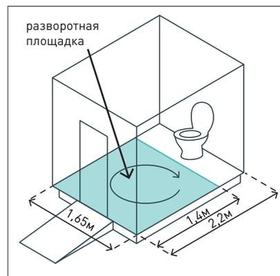
Необходимо обеспечить доступ в туалеты для МГН. Внутри одной из кабин обустраивается свободное пространство для маневрирования диаметром  $\geq 1,4\text{ м}$ . Габариты —  $1,65 \times 2,2\text{ м}$ .
