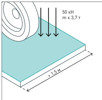
Для доступа проезда дорожно-уборочной техники: ширина проезда  $\geq 1,5$  м, устойчивость покрытия к нагрузке ( $\leq 3,7$  т)
