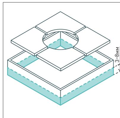
Приствольные решетки необходимо устанавливать на каркас, приподнимая от уровня грунта на 50 мм. Место посадки отсыпать гнейсом на 3–8 мм.
