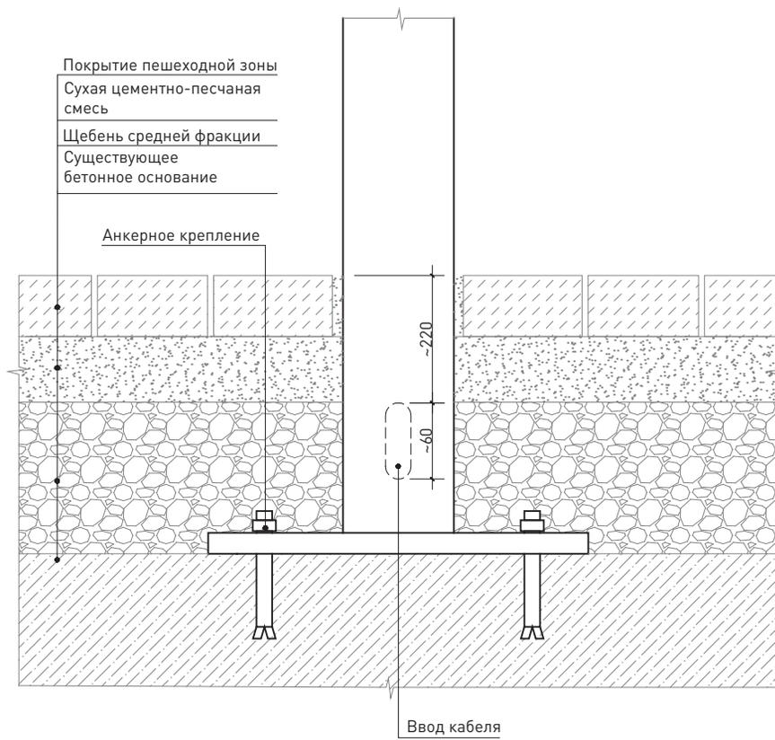
94 Схема установки светильника в газоне / сечение
