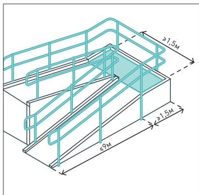
Каждые 9 м пандуса предусматривается горизонтальная площадка размером  $\geq 1,5 \times 1,5$  м, в местах интенсивного пользования —  $\geq 2,1 \times 2,1$  м.
