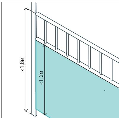
Ограждения не должны нарушать визуальную проницаемость территории. Максимальная высота сплошных ограждений — 1,2 м, прозрачной части — 1,8 м.
