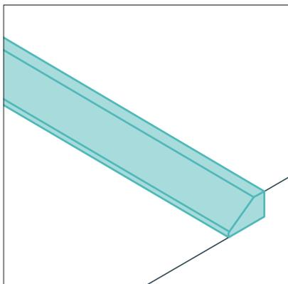
При спуске велодорожки относительно тротуара следует использовать камень-аппарель в качестве элемента сопряжения.
