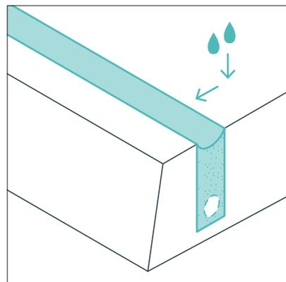
Вдоль подпорных стен следует предусмотреть отвод поверхностных стоков.
