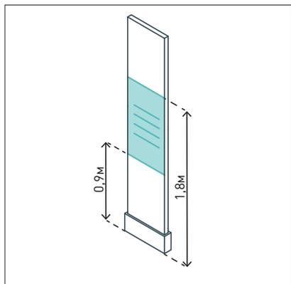
На навигационных стенах основной блок информации должен располагаться на высоте 0,9–1,8 м.
