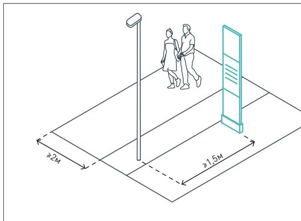
Минимальный отступ от опор освещения, светофоров, вывесок, входов до элемента навигации — 1,5 м. Свободное пространство для пешеходов  $\geq 2$  м. Следует размещать элементы с учетом сохранения обзорности для участников движения как на линейных участках движения, так и на перекрестках и пешеходных переходах.
