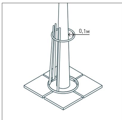
Расстояние от приствольного ограждения до ствола дерева  $\geq 0,1$  м. Для поддержки дерева возможна установка системы креплений.
