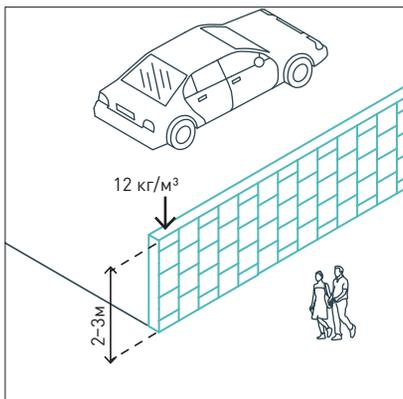
Шумозащитные экраны должны быть высотой 2–3 м из сплошного непористого материала плотностью  $\geq 12 \text{ кг/м}^3$ .
