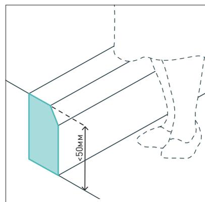
При отсутствии возможности установки направляющей навигации на тротуаре ее функцию может выполнять бортовой камень высотой  $\geq 0,05$  м.
