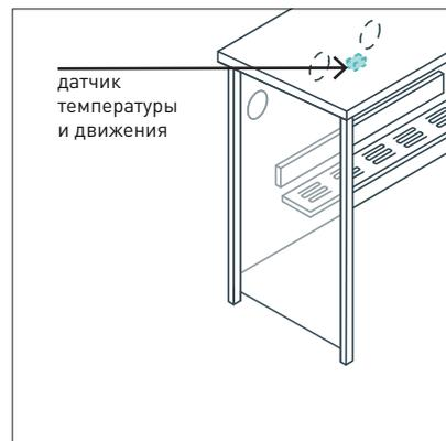
При устройстве обогреваемой остановки следует устанавливать контроль подачи тепла с регулировкой расхода электроэнергии в зависимости от температуры и числа людей.
