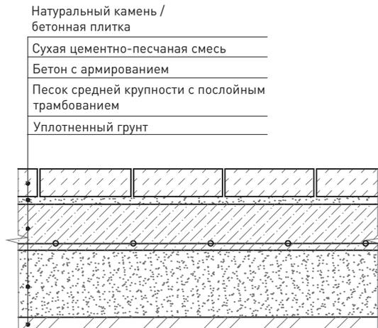
3 Схема устройства основания под проницаемое мощение из бетонной плитки / натурального камня
