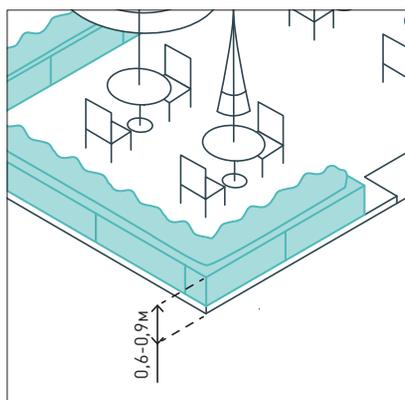
Для обозначения границ террасы используются контейнеры с озеленением либо декоративные ограждения высотой  $0,6 - 0,9 \text{ м}$  (до  $1,8 \text{ м}$  для регулируемых экранов в разобранном состоянии).
