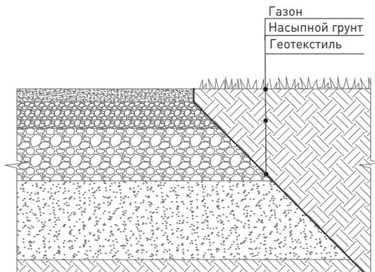
27 Схема устройства сопряжения покрытий при помощи дренажной полосы из гравия
