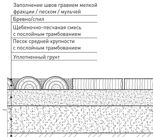
15 Схема устройства основания под террасный настил из древесины
