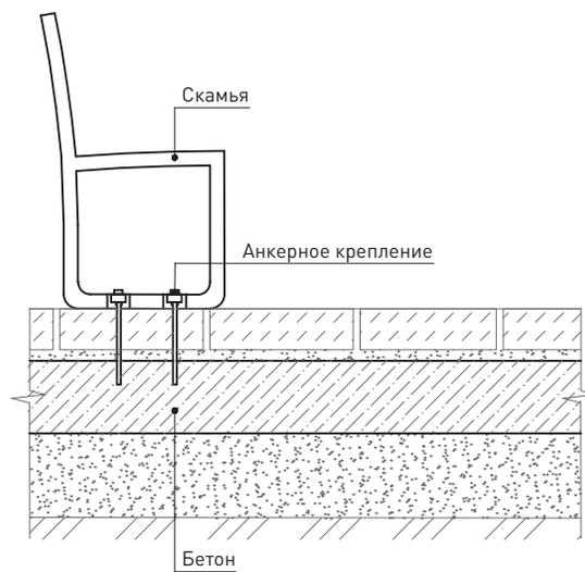
74 Схема установки велопарковки в мягкое покрытие
