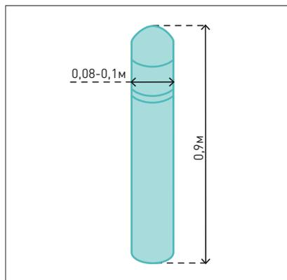
Габариты ограничителя-стойки: высота 0,9 м, диаметр стойки 0,08–0,1 м. Необходимо использование светоотражающих лент, подсветки.
