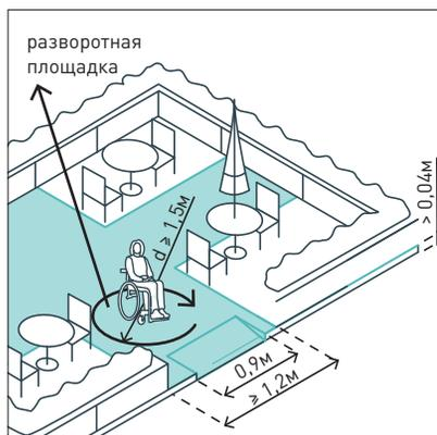
Для МГН предусматривается проход между столиками  $\geq 1,2 \text{ м}$  и зона разворота диаметром  $\geq 1,5 \text{ м}$  (при отсутствии сквозного прохода). При возвышении террасы оборудуется пандус шириной  $0,9 \text{ м}$ .
