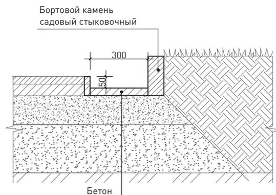
**35** Схема устройства водоотводного желоба со стыковочным бортовым камнем
