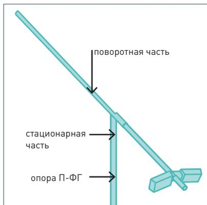
При невозможности обслуживания специализированной техникой опор выше 5 м применяются складные опоры типа П-ФГ.
