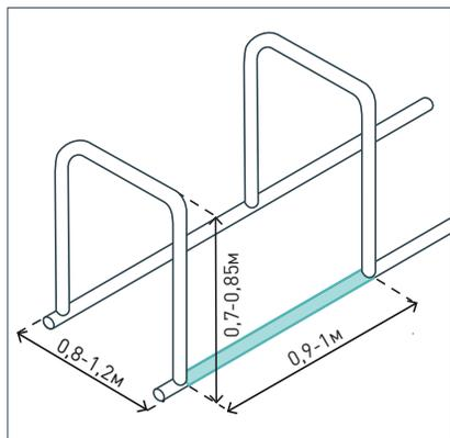
Высота стойки велопарковки должна составлять 0,7–0,85 м. Рекомендуемая длина стойки велопарковки — 0,8–1,2 м. Расстояние между стойками групповых велопарковок: перпендикулярных — 0,9–1 м; параллельных — 2 м; под углом 30° — 1,3 м; под углом 45° — 1,35 м.
