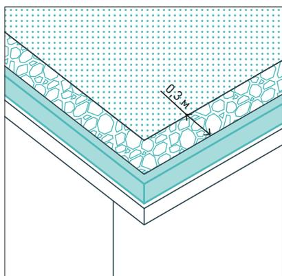
По краю крышного озеленения следует предусмотреть отсыпку гравием шириной 300 мм, а также бортовой элемент.
