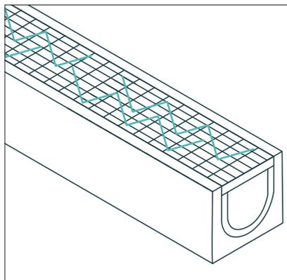
Следует обеспечить высокий коэффициент сцепления поверхности водоотводных элементов для предотвращения скольжения.
