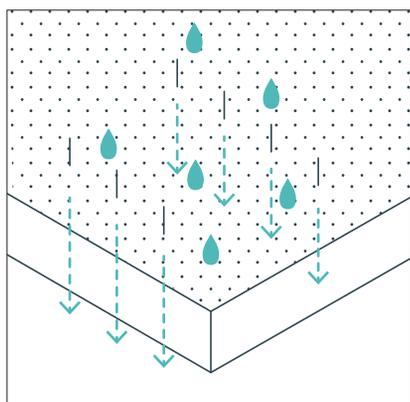
На больших участках мощения, парковых территориях для отвода осадков в грунт и насыщения влагой растений следует использовать водопроницаемые покрытия
