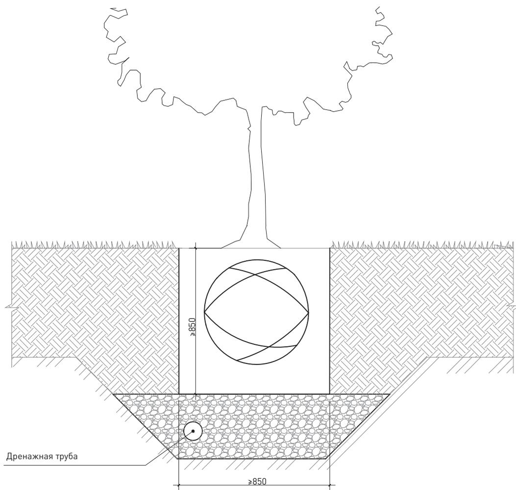
79 Схема устройства системы орошения / сечение
