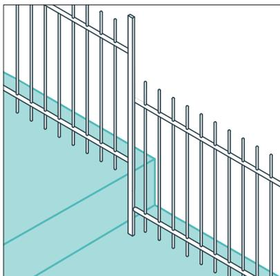
При установке на рельефе следует обеспечить возможность крепления элементов к стойкам на разных уровнях.
