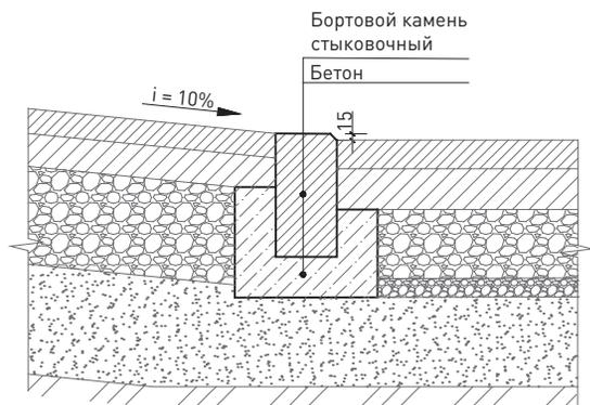
**34** Схема устройства сопряжения покрытий при помощи бордюрного камня
