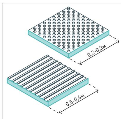
Ширина тактильной предупреждающей полосы —  $0,5-0,6$  м, ширина тактильной направляющей полосы —  $0,2-0,3$  м.
