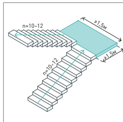
Каждые 10–12 ступеней необходимо обустроить горизонтальную площадку  $\geq 1,5 \times 1,5$  м, в местах интенсивного пользования —  $\geq 2,1 \times 2,1$  м.
