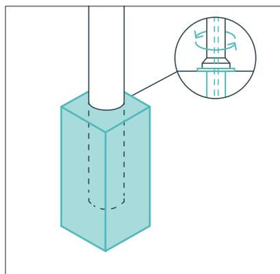
Стационарные ограничители монтируются при помощи бетонирования/анкерки к бетонному основанию. Для съемных ограничителей следует устанавливать закладные детали.
