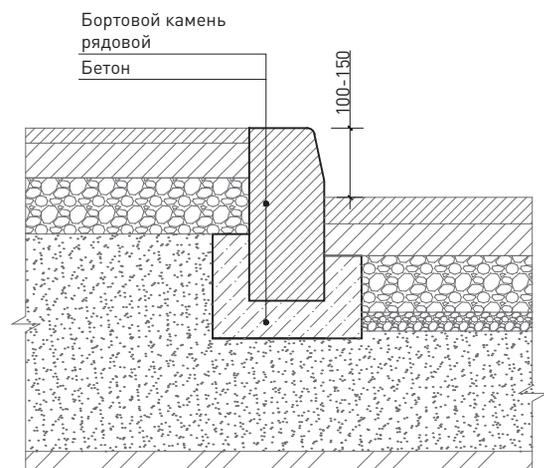
**36** Схема устройства открытого лотка водоотведения
