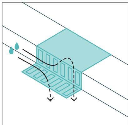
Целесообразно устанавливать дождеприемник с вертикальным забором для повышения дождеприемной способности в момент пиковых осадков.
