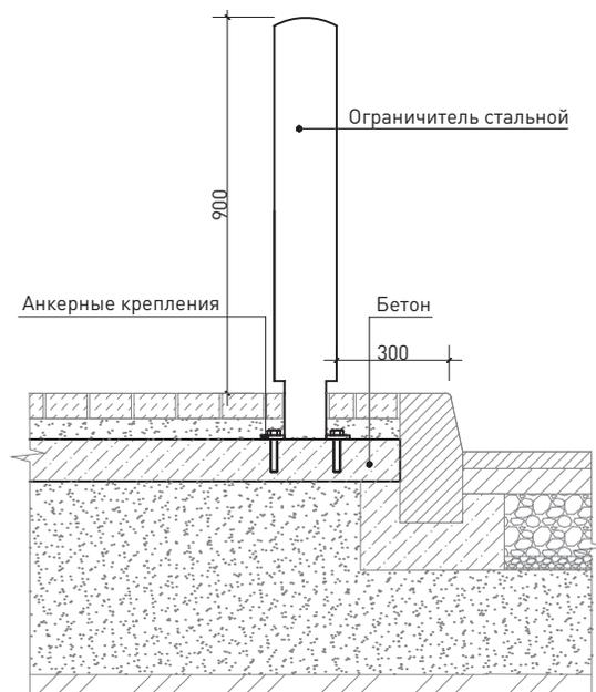
54 Схема установки стального съемного ограничителя парковки на ключе
