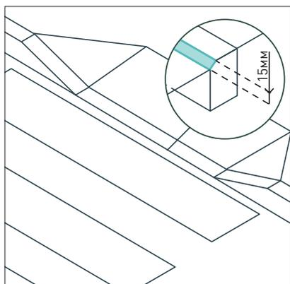
Допускается перепад относительно проезжей части  $\leq 15$  мм — с плавным переходом-фаской ограничивающего элемента.
