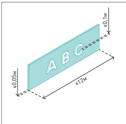
Высота плоской вывески — 500–700 мм, длина определяется зоной размещения, не более 12 м. Глубина подложки ≤ 0,05 м, вывески ≤ 0,1 м.
