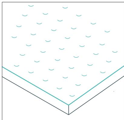
Поверхность — ровная шероховатая, противоскользящая, не создающая вибраций при движении. Коэффициент сцепления: 0,6 (сухое покрытие);  $\geq 0,4$  (влажное покрытие).
