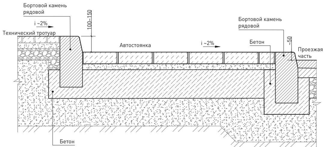
46 Схема устройства бордюрного пандуса с понижением бортового камня
