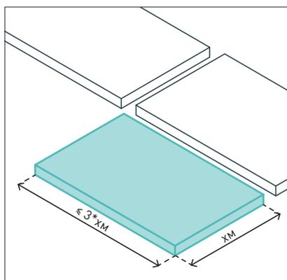
Отношение ширины плитки к ее длине  $\leq 1:3$ . Максимальный перепад высоты между сборными элементами — 2 мм
