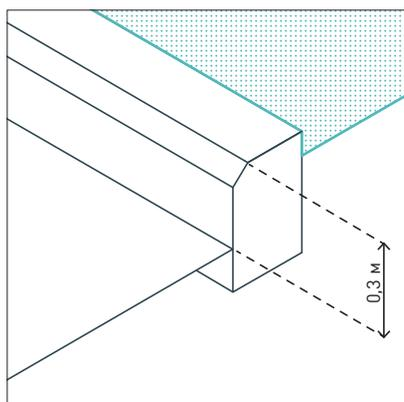
При возможности попадания в зону озеленения противогололедных реагентов рекомендуется поднятие уровня на 0,3 м над уровнем прилегающего покрытия.
