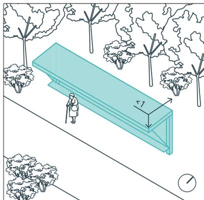
Для предотвращения перегрева следует выбирать поверхности элементов с высоким коэффициентом альбедо (число, максимально приближенное к 1).
