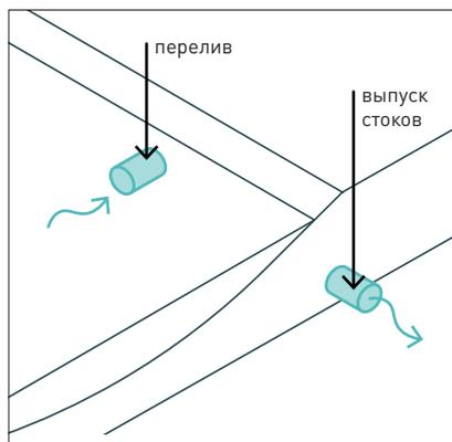
Инфильтрирующие элементы следует снабжать водосливными трубами (переливами), отводящими избыток воды в систему ливневой канализации.
