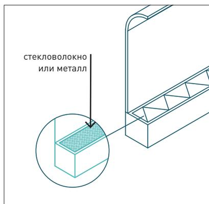
Элементы уличной мебели с термически активными элементами рекомендуется выполнять из материалов с высокой теплопроводностью (стекловолокна или металла).
