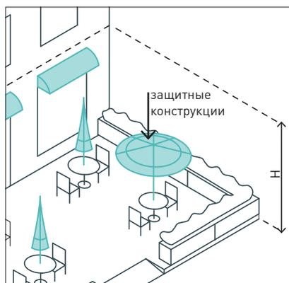
При размещении кафе возле здания защитные конструкции и элементы освещения не должны быть выше первого этажа. Размещение логотипов должно соответствовать правилам (см. раздел «Элементы фасадов»).
