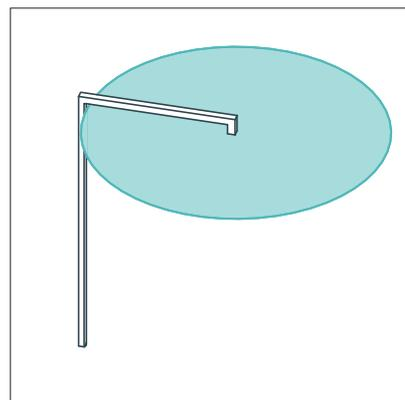
Возможно обустройство круглого навеса на опорах. Высота и диаметр навеса могут варьироваться так, чтобы максимальная защита от прямых лучей обеспечивалась в полдень.
