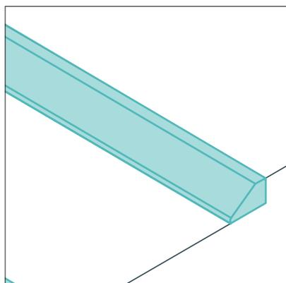
Для обособления опущенной велодорожки возможно использование бортового камня-аппареля.
