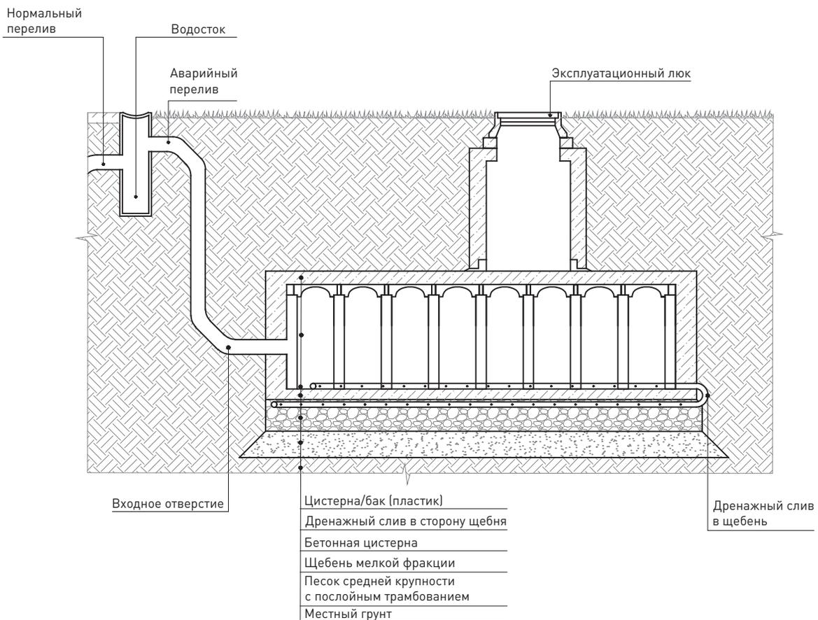
**118** Модульная система резервуаров
