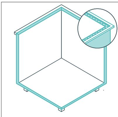
Следует предусматривать теплоизоляцию конструкции для предотвращения промерзания грунта.
