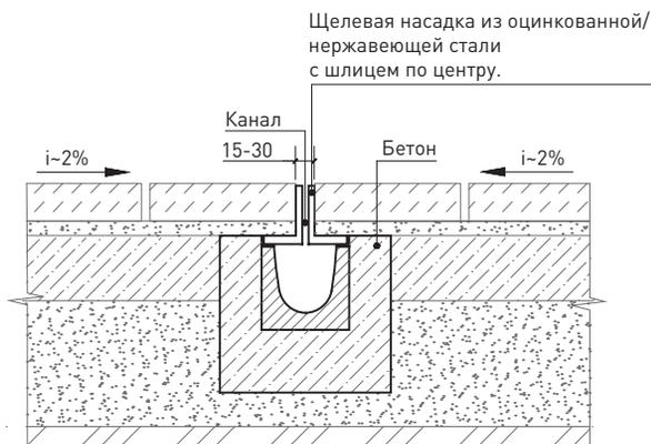
40 Схема устройства внутреннего дренажа автостоянки с покрытием из асфальтобетона / сечение
