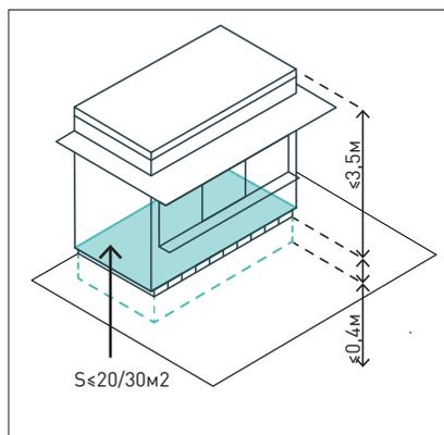
Высота конструкции  $\leq 3,5\text{ м}$ , заглубление — до  $0,4\text{ м}$ . Общая площадь  $\leq 20\text{ м}^2$  для киосков,  $30\text{ м}^2$  для павильонов, в том числе при группировке нескольких элементов в один блок.
