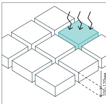
При использовании мощения для предотвращения разрушения следует использовать мелкоштучные элементы, ввиду высоких нагрузок и интенсивности использования толщина плитки покрытия автостоянок должна быть  $\geq 100$  мм.
