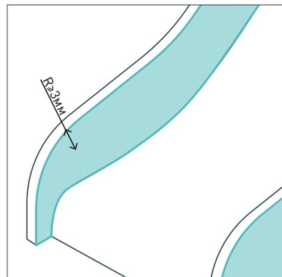
Все острые углы элементов должны иметь скругление радиусом  $\geq 3$  мм.
