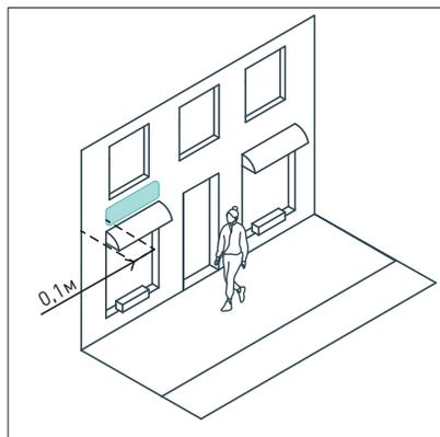
Отступы от границ зоны размещения до расположения плоской вывески, панель-кронштейна —  $0,1\text{ м}$ , от архитектурных элементов фасада до зоны размещения вывесок —  $0,1\text{ м}$ .
