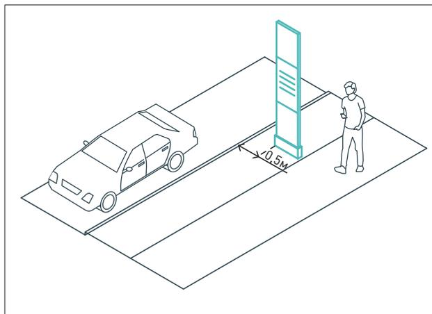
При установке элементов в технической зоне тротуара расстояние от края проезжей части до опоры указателя необходимо назначать  $\geq 0,5$  м.
