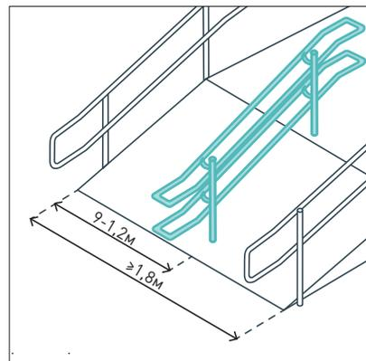
Ширина пандуса с двусторонним движением  $\geq 1,8$  м, с центральным поручнем для возможности держаться с обеих сторон на расстоянии 0,9–1,2 м до боковых поручней.
