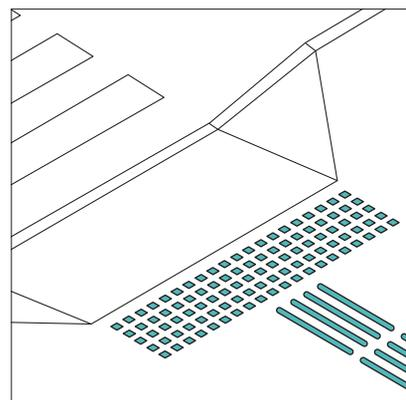
В качестве тактильных дорожных указателей следует применять бетонные плиты, индикаторы из полиуретана / нержавеющей стали.
