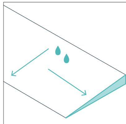
Поперечный уклон поверхности из асфальто-/цементобетонных покрытий — 1,5%, сборных плитных — 1,5–2%, мягких — 1,5%. Максимальный продольный уклон — 6%
