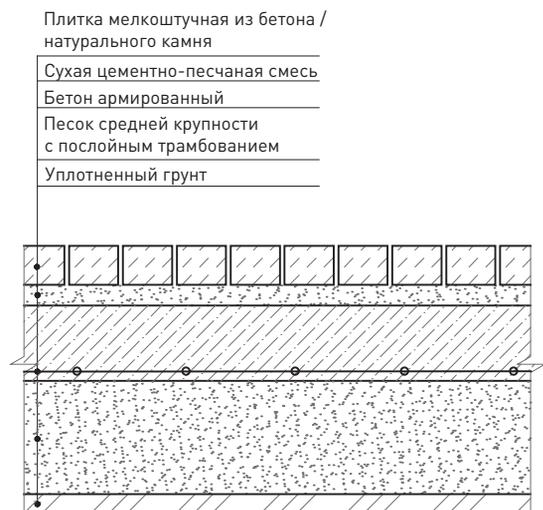
8 Схема устройства основания под набивное покрытие
