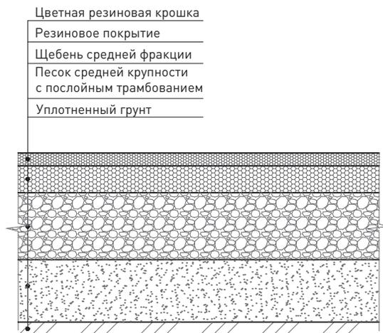
19 Схема устройства основания под мелкозернистую каменную крошку
