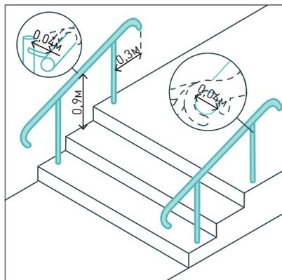
Высота поручней — 0,9 м. Поручни должны быть непрерывными, с закругленными выступами длиной 0,3 м в начале и конце лестницы. Расстояние между поручнем и точкой крепления  $\geq 0,04$  м.
