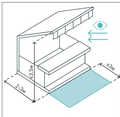
Высота конструкции  $\leq 3,5$  м, ширина 2–3 м. Ширина прохода для пешеходов  $\geq 3$  м (1,5–2 м в стесненных условиях). Необходимо обеспечить просматриваемость конструкций — открытые или остекленные прилавки (витрины).
