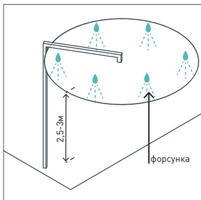
В укрытиях, оборудованных системами адиабатического охлаждения, форсунки для распыления воды следует устанавливать на высоте 2,5–3 м от земли.
