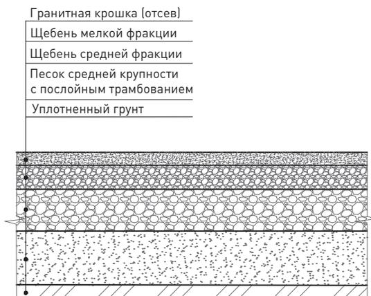
9 Схема устройства основания под проникаемое мощение из колотого штучного камня
