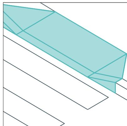
Для обеспечения плавного перехода с тротуара на проезжую часть следует использовать бордюрный пандус или понижение мощения.
