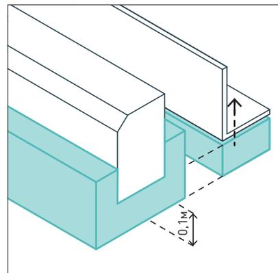
Бортовые камни и металлические разделители должны быть надежно установлены на бетонное основание, угловые металлические разделители фиксируются анкерами.
