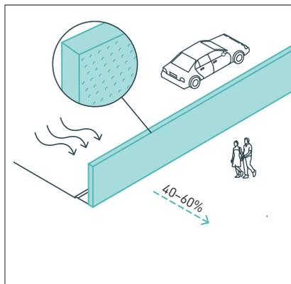
Ветрозащитные барьеры должны пропускать 40–60% воздуха (соответствует пористости материала 25–33%), чтобы не создавать вихревые потоки и гасить скорость ветра.
