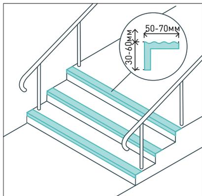
Для предупреждения соскальзывания возможно применение защитного углового профиля на всех ступенях шириной 0,05–0,065 м на проступи и 0,03–0,055 м на подступенке.
