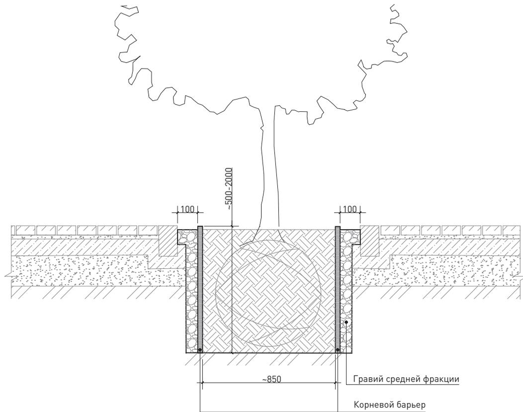
**83** Схема устройства закрытого заглубленного стационарного контейнера с системой закрепления корневого кома / сечение
