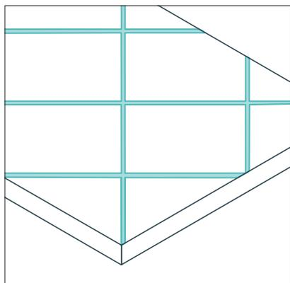
Плиты мощения — крупногабаритные без фасок, укладываются по диагонали или длинной стороной поперек движения велосипедистов. Толщина шва —  $\leq 5$  мм.
