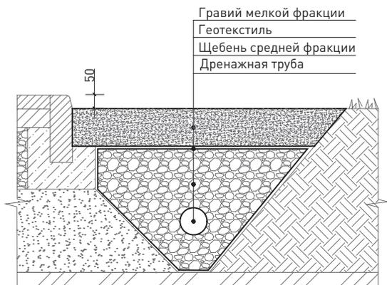
28 Схема устройства сопряжения покрытий при помощи деревянного бордюра
