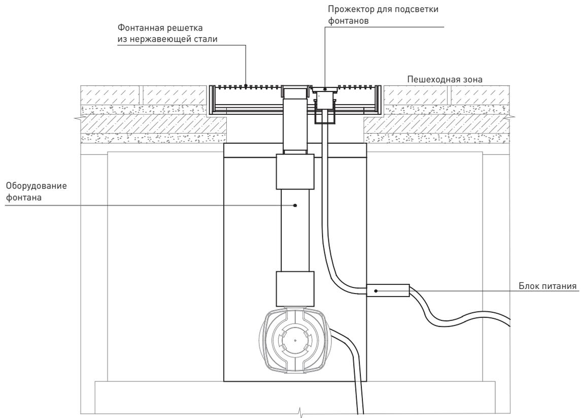
96 Схема установки светильника в покрытие /
