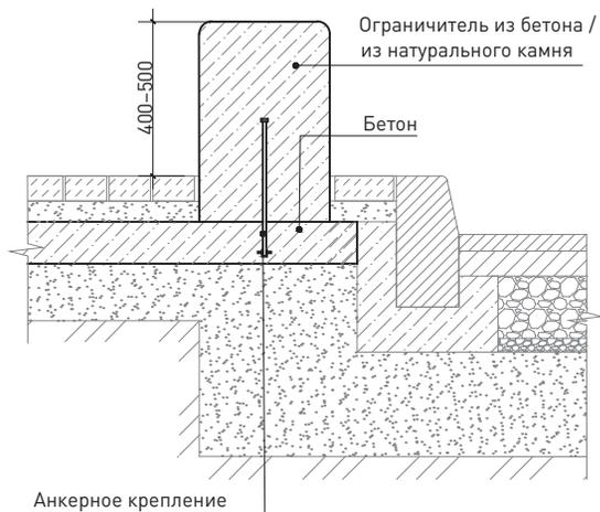
56 Схема установки ограничителя из бетона (натурального камня)
