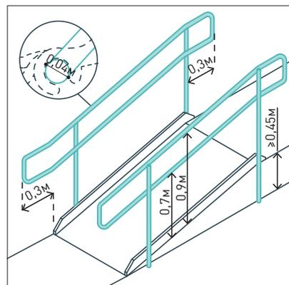
Поручни должны быть непрерывными по всей длине, с закругленными выступами длиной 0,3 м. Рекомендованный диаметр — 0,4 м. Расстояние между поручнем и точкой крепления  $\geq 0,4$  м, шаг стоек — 0,9–1,1 м.
