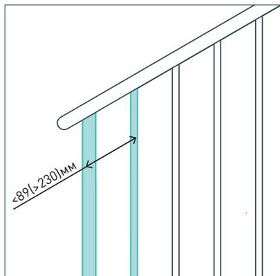
Расстояние между перекладинами на лестницах, а также в ячейках канатных сеток должно быть  $< 0,089$  м или  $> 0,23$  м.
