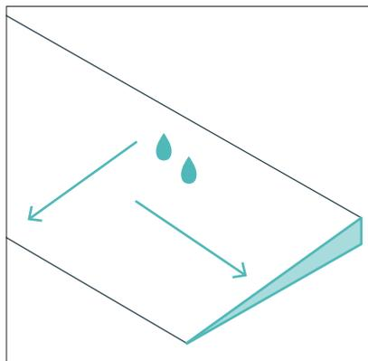
Поперечный уклон поверхности из асфальто-/цементобетонных покрытий — 1,5%, сборных плитных — 1,5–2%. Минимальный — 0,5% для обеспечения водоотвода. Максимальный продольный уклон — 2%.
