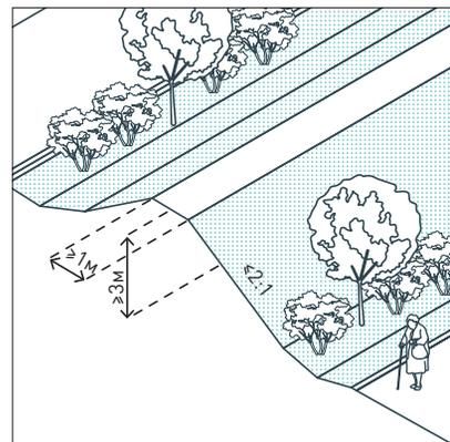
Минимальная высота шумозащитной насыпи — 3 м. Максимальный уклон насыпи — 2:1. Верх насыпи — горизонтальная площадка шириной  $\geq 1 \text{ м}$ .
