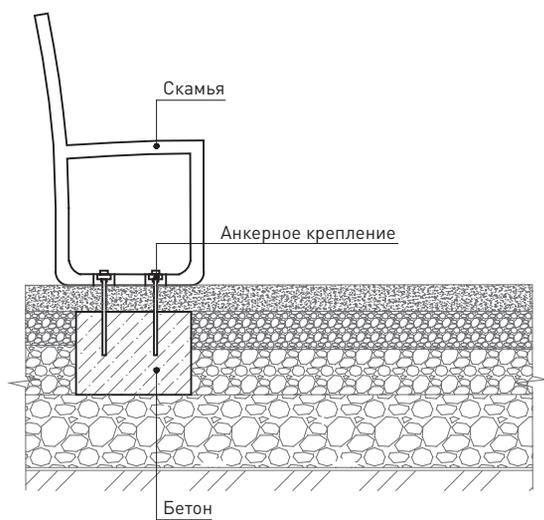
73 Схема монтажа скамьи в твердое покрытие
