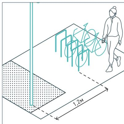
Стойки велопарковок следует располагать на расстоянии 1,2 м от других элементов благоустройства (скамьи, фонари и т. п.).
