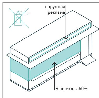
Остекленная поверхность должна занимать  $\geq 50\%$  площади фасада. Фасады рекомендуется обрабатывать покрытием антиграффити. На глухих поверхностях возможно размещение наружной рекламы.
