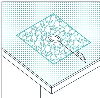
Вокруг дождеприемной воронки следует предусмотреть участок, свободный от озеленения на расстоянии 750 мм, с заполнением гравийной отсыпкой.
