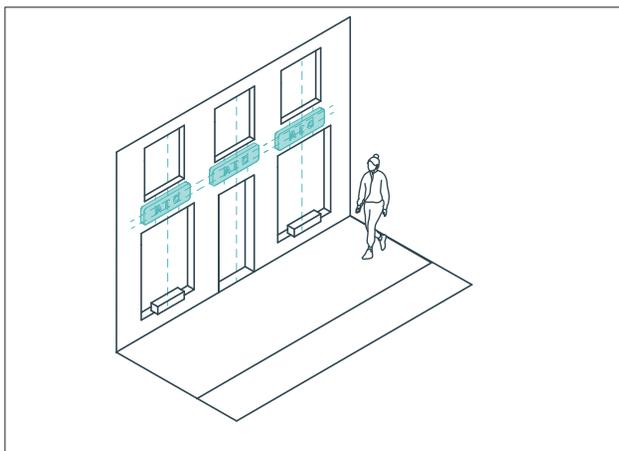
Информация должна быть симметрична относительно осей подложки, панели, архитектурных элементов или зоны размещения.
