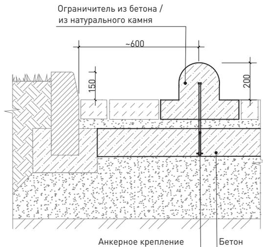
55 Схема установки электромеханического болара (выдвижного ограничителя в мощение)
