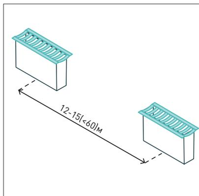
Шаг дождеприемников определяется по расчету поступающего стока, в местах понижения уровня рельефа рекомендуемый шаг — 12–15 м, но  $\leq 60$  м. Шаг пескоуловителей определяется также по расчету поступающего стока.
