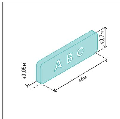
Высота лайтбокса ≤ 0,7 м, длина ≤ 6 м, определяется зоной размещения. Глубина лайтбокса ≤ 0,18 м.
