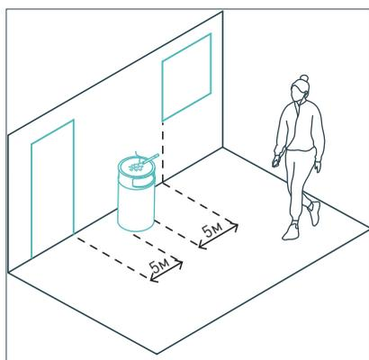
Урны с установленными на них пепельницами следует размещать на расстоянии 5 м от окон жилых домов и входов в здания.
