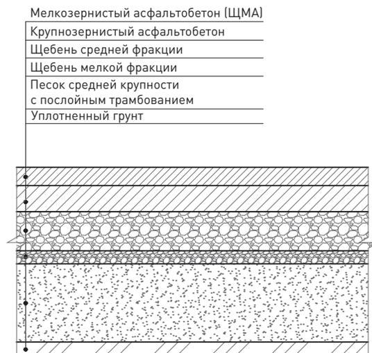
7 Схема устройства основания под мелкоштучную бетонную плитку / плитку из натурального камня
