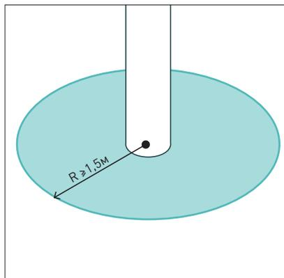
Рекомендуемый радиус пролищаемого покрытия от ствола дерева при отсутствии приствольной решетки  $\geq 1,5$  м.
