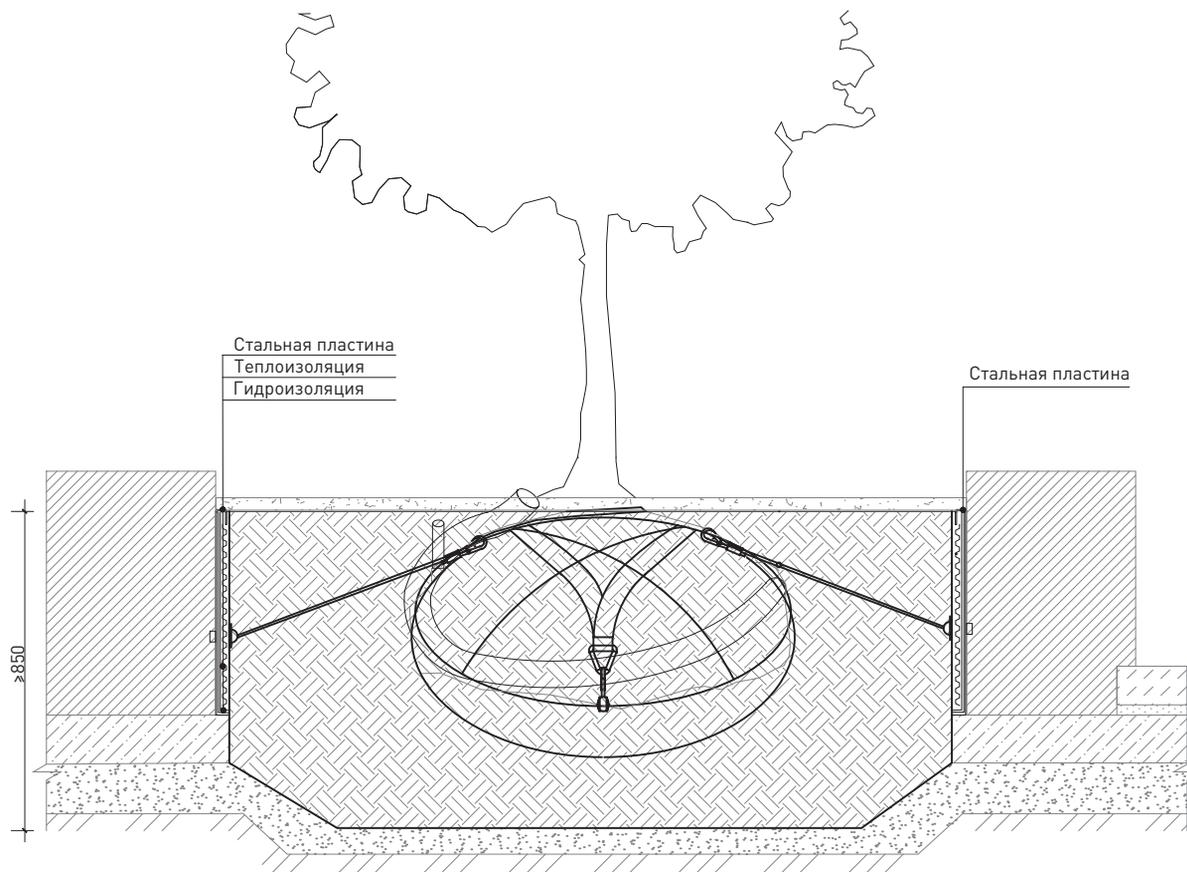
85 Схема устройства заглубленного стационарного контейнера над инженерными сетями / сечение
