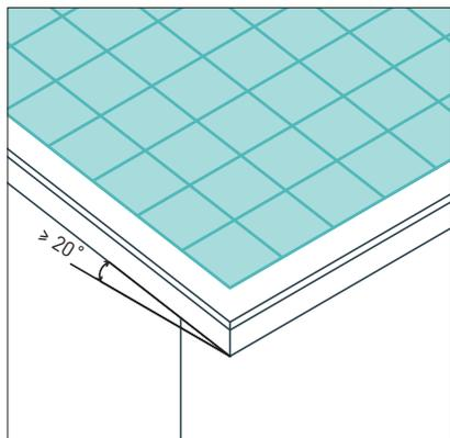
Уклон  $\geq 20^\circ$  следует укреплять георешеткой от сдвигов, оползней из-за высокой скорости дождевых потоков.
