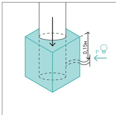
Выдвижные ограничители следует оборудовать системой обогрева и подсветкой через выпускной канал из бетонного основания на глубине заложения 1 м.
