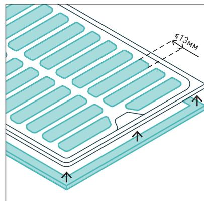
Дождеприемные решетки монтируются на резиновые прокладки. Ширина пазов для тротуаров  $\leq 13$  мм, проезжей части — 18–25 мм, длина  $\leq 170$  мм. Ориентация пазов — перпендикулярно направлению движения / по диагонали.
