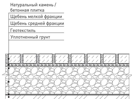
10 Схема устройства основания под укрепленный газон
