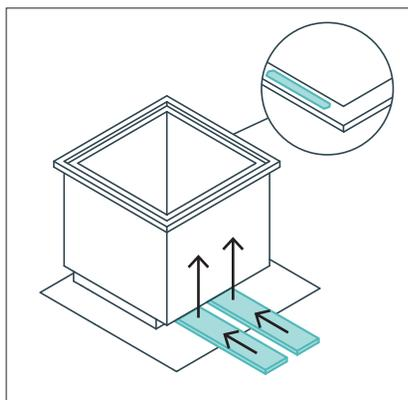
Для удобства демонтажа в конструкции контейнеров должны быть предусмотрены пазы для механизированного подъема.
