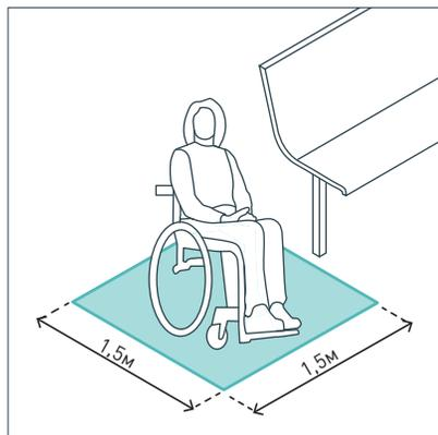
При установке мест для сидения на твердые покрытия рядом обустроивается площадка для остановки инвалидных кресел или детских колясок ( $\geq 1,5 \times 1,5$  м).
