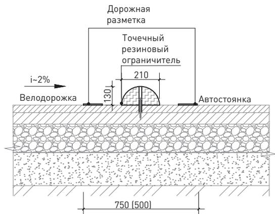
58 Схема установки дорожного разделителя из бетона
