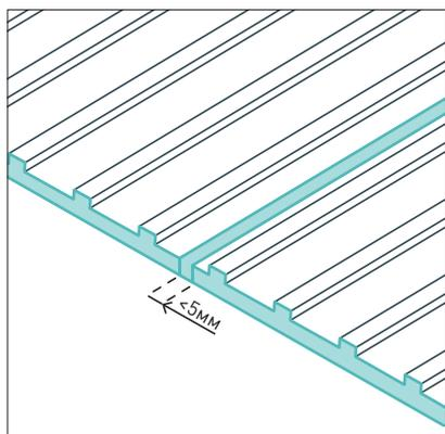
Следует использовать материалы с рифленой противоскользящей поверхностью. Коэффициент сцепления  $\geq 0,6$ ; во влажном климате  $\geq 0,4$ . Толщина шва  $\leq 5$  мм.
