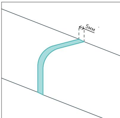
Элементы необходимо укладывать без зазоров, швы между элементами  $\leq 5$  мм.
