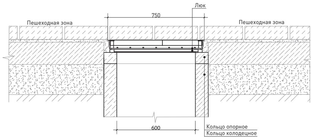
101 Схема устройства квадратного люка в покрытие / сечение
