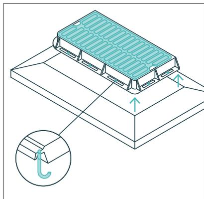
Конструкция дождеприемных решеток оснащается запорным устройством с усиленной заделкой корпуса при помощи анкерных болтов / специальных приливов для подъема.
