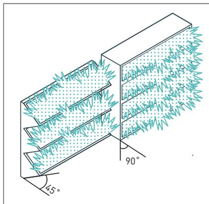
Взрослые растения рекомендуется высаживать в модульные системы вертикального озеленения под углом 45° и 90° относительно плоскости модуля.
