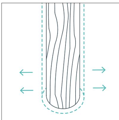
Деревянные изделия необходимо обрабатывать водоотталкивающей защитной пропиткой для предотвращения гниения и заиливания.
