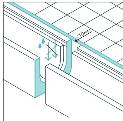
Сборные элементы линейного водоотвода следует соединять паз-гребнем. Швы между покрытием и элементом ( $\leq 10$  мм) должны быть герметичными.
