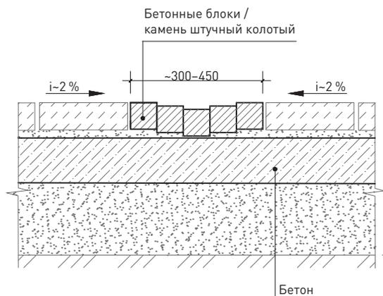
38 Схема устройства закрытого лотка водоотведения
