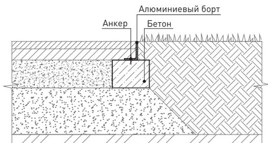
26 Схема устройства сопряжения покрытий без элементов сопряжения
