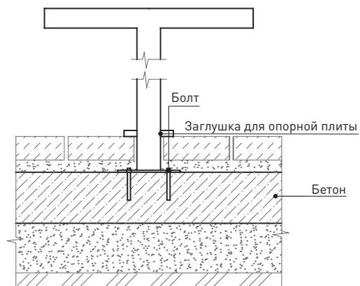
68 Схема установки стола при помощи анкерной плиты
