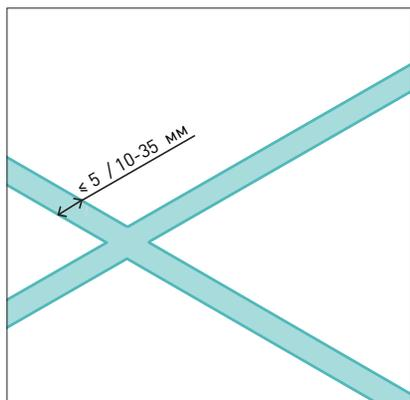
Следует соблюдать цельность покрытия, без зазоров. Швы  $\leq 5$  мм — для непроницаемого мощения, 10–35 мм — проницаемого.
