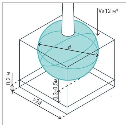
Ширина посадочного места равна 2 диаметрам корневого кома, глубина ниже на 0,3–0,5 м + 0,2 м дренажного слоя. Объем посадочной ямы  $\geq 12 \text{ м}^3$ .
