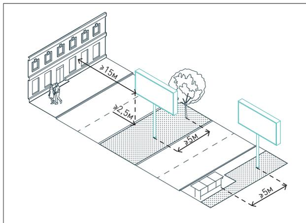
Билборды следует размещать в местах озеленения и на разделительных полосах главных улиц. Билборд  $6 \times 3$  м разрешено устанавливать на расстоянии  $\geq 5$  м от НТО и павильонов ОТ,  $\geq 15$  м от фасадов зданий,  $\geq 5$  м от стволов деревьев. Размещение билборда возможно при наличии  $\geq 2,5$  м от краев разделительной полосы.
