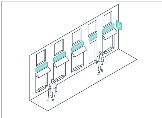
Зона размещения плоской и витринной вывески, лайтбокса, таблички зависит от архитектурного решения фасада — должна быть симметричной по отношению к архитектурным элементам фасада. Зона размещения панель-кронштейна совпадает с уровнем размещения вывесок первого этажа.
