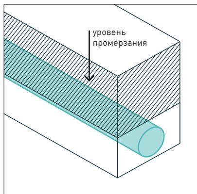
Дренажная труба инфильтрирующих элементов должна быть ниже уровня промерзания грунта.
