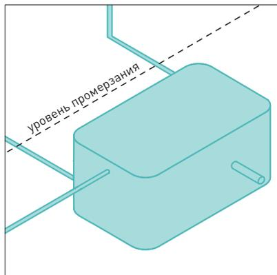
Подземные резервуары и входной патрубков размещаются ниже нормативной глубины промерзания грунта / опустошаются перед началом зимы.
