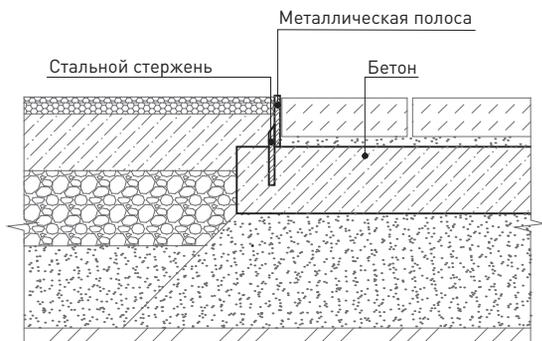
24 Схема устройства сопряжения покрытий при помощи борта из металлического уголка
