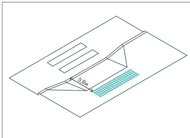
Предупреждающие указатели (тактильная плитка, отличное от основного мощение) следует располагать на расстоянии  $\geq 0,8$  м до препятствия (пешеходного перехода, лестницы и т.п.).
