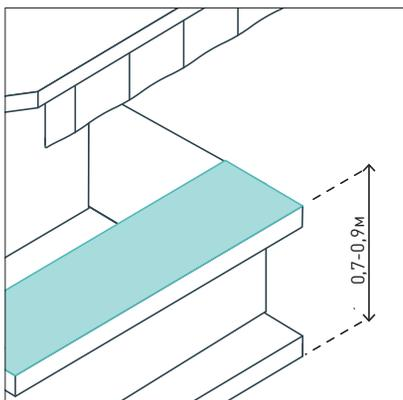
Для комфорта МГН следует обеспечить высоту прилавка 0,7–0,9 м (допускается высота до 1,3 м).
