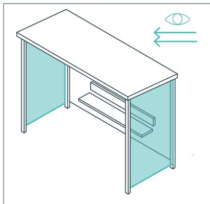
Следует обеспечить видимость подъезжающего транспорта для людей внутри остановочного павильона — боковые стенки остановочных павильонов должны быть прозрачными.
