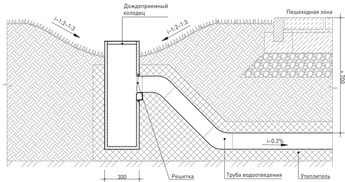
112 Схема устройства водоотведения
