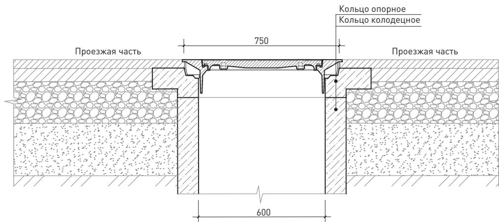
104 Схема устройства дождеприемника
