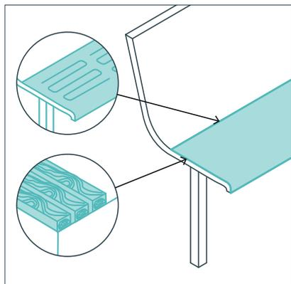
Поверхности мест для сидения следует выполнять из материалов с низкой теплопроводностью для круглогодичного комфорта.
