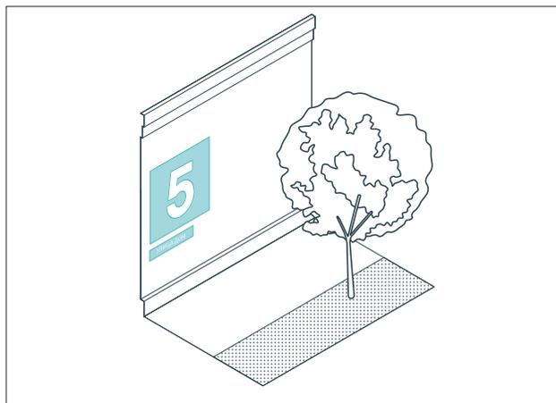
Адресные таблички размещаются на фасадах зданий над окнами первых этажей. Если ширина улицы более 80 м, для лучшей видимости размещайте информацию с адресом дома на глухом фасаде крупным форматом. Таблички должны плотно прилегать к стене и не перекрывать архитектурные детали.
