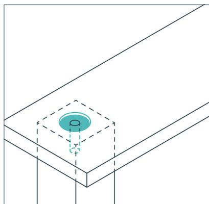
Крепления элементов должны быть скрытыми для исключения их демонтажа без применения инструментов.
