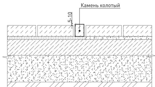
32 Схема устройства сопряжения покрытий при помощи камня-аппареля
