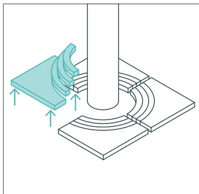
Решетки должны быть модульными: состоять из 2–4 частей с возможным увеличением количества модулей для расширения пространства при росте дерева.
