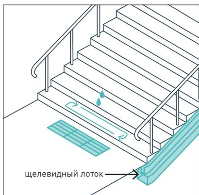
Для водоотвода возможно использовать лоток вдоль боковой грани марша лестницы / закрытого дождеприемника у основания. Дополнительно возможен подогрев ступеней.
