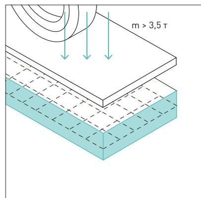
Пешеходные тротуары, на которых подразумевается возможность проезда а/м нагрузкой  $> 3,5$  т, следует укреплять при помощи армирования несущего слоя
