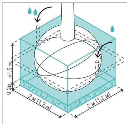
Размеры посадочного места  $\geq 2 \times 2$  м, глубина — 1,5 м + дренаж. В стесненных условиях допускается 1,2  $\times$  1,2 м с увеличением глубины при условии установки трубок аэрации и полива.
