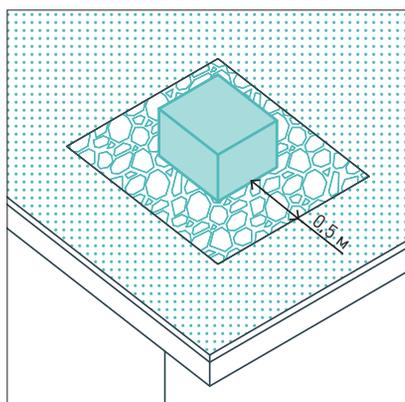
Вокруг выступающих конструкций (стены, световые фонари, вентиляционные шахты) следует предусмотреть отсыпку шириной  $\geq 500$  мм.
