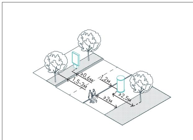
Рекламные конструкции нельзя размещать на разделительных полосах движения и в пределах видимости водителей автомобилей. Расстояние от проезжей части до конструкции должно быть  $\geq 0,6$  м.
