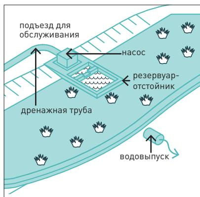
Для сброса стоков в водные объекты необходима их предварительная очистка через ВБУ, которые состоят из пруда-отстойника глубиной  $< 3$  м, насоса, фильтрационных отсеков, перелива и водовыпуска.
