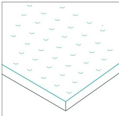
Следует использовать материалы с шероховатой, противоскользящей, не создающей вибраций поверхностью. Коэффициент сцепления: 0,6 — сухое,  $\geq 0,4$  — влажное.
