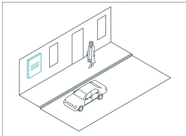
В стесненных условиях, но при свободных стенах возможна установка настенных информационных табличек на высоте 0,9–2,5 м.
