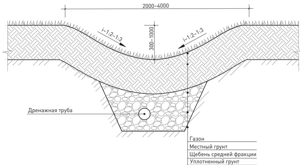
116 Схема устройства биодренажной канавы,
