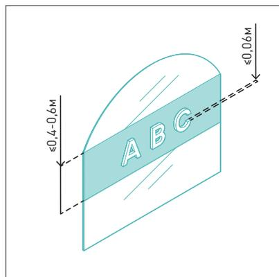
Высота витринных вывесок для постоянного оформления — 0,4–0,6 м. Ширина соответствует ширине витрины. Глубина объемных витринных вывесок ≤ 0,06 м
