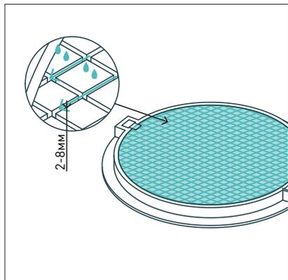
Поверхность крышки должна быть шероховатой, с высотой рельефа 2–8 мм. Рисунок рельефа должен быть открытым для быстрого отвода стоков.
