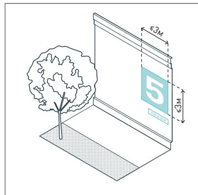
Размер крупноформатной адресной навигации на глухом фасаде  $\leq 3 \times 3$  м.
