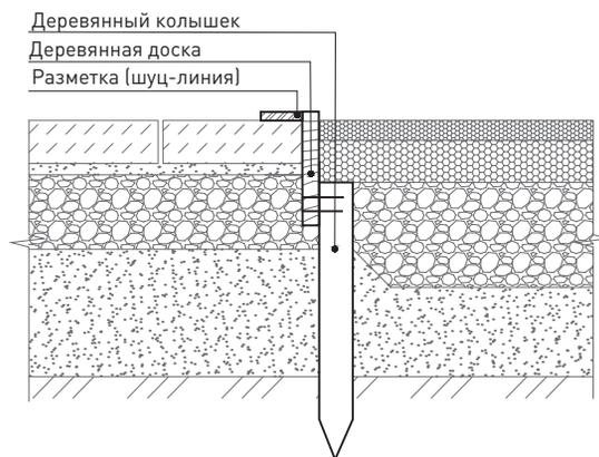
31 Схема устройства сопряжения покрытий при помощи стыковочного элемента мощения (плитка из бетона / натурального камня)
