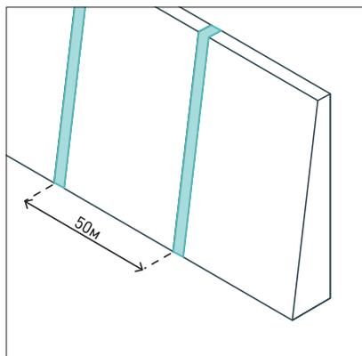
Подпорные стены следует разделять на секции сквозными деформационными швами с шагом 50 м.
