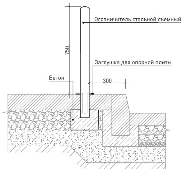
57 Схема установки ограничителя парковки (низкого/высокого) из бетона (натурального камня)
