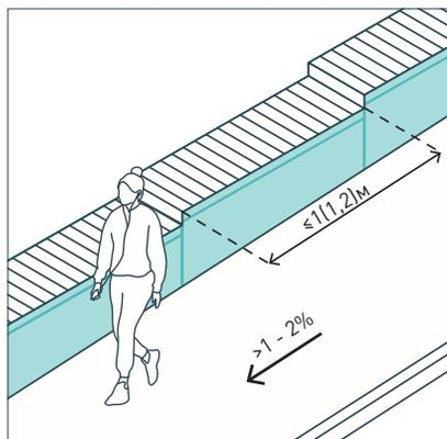
При уклоне покрытия более 1–2% (вдоль продольной стороны элементов сидений) следует устанавливать элементы/модули длиной не более 1–1,2 м.
