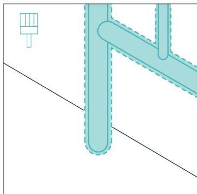
Металлические ограждения необходимо покрывать антикоррозионными материалами (горячее цинкование, эмали, грунтовки) и огнеупорными красками.
