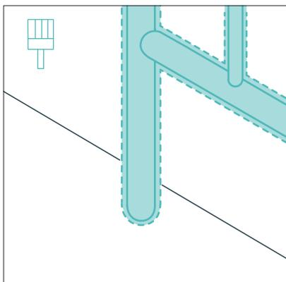
Металлические ограждения обрабатываются антикоррозионными покрытиями (горячее цинкование, эмали, грунтовки), огнеупорными красками, устойчивыми к сырости.
