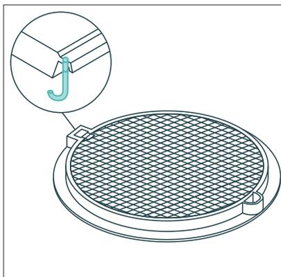
Корпус люка следует усиленно заделывать при помощи анкерных болтов.
