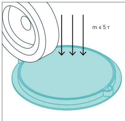
Выбор люков должен соответствовать расчетным нагрузкам (тяжелые люки — проезжая часть, легкие — пешеходная зона и проезды, с нагрузкой до 5 т).
