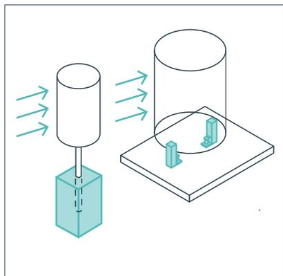
Элементы должны быть прочно и надежно прикреплены к фундаментам при помощи бетонирования или анкерного крепления.
