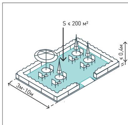
Обустриваются в одном уровне с пешеходной зоной или на платформе  $\leq 0,4 \text{ м}$ . Ширина площадки сезонного кафе  $\geq 1 \text{ м}$ , рекомендуемая — 3–10 м. Площадь кафе — до  $200 \text{ м}^2$ , фуд-кортов — до  $1500 \text{ м}^2$ .
