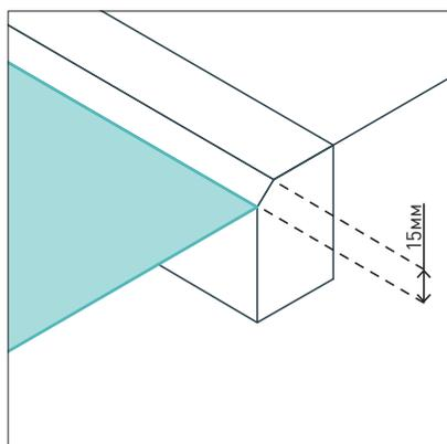
Для сопряжения твердых покрытий с насыпными рекомендуется использование рядового бортового камня с понижением уровня насыпного покрытия на 15 мм.
