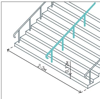
При высоте лестницы  $\geq 0,45$  м необходимо монтировать поручни с обеих сторон. При ширине открытой лестницы  $\geq 2,5$  м устанавливаются разделительные поручни.
