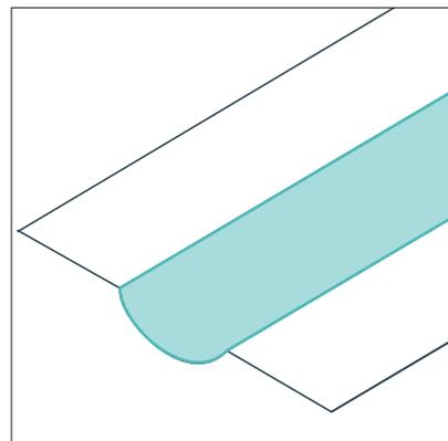
Для обеспечения отвода воды используется открытый лоток из мелкоштучного мощения или обустраивается дренажная полоса из гравия.
