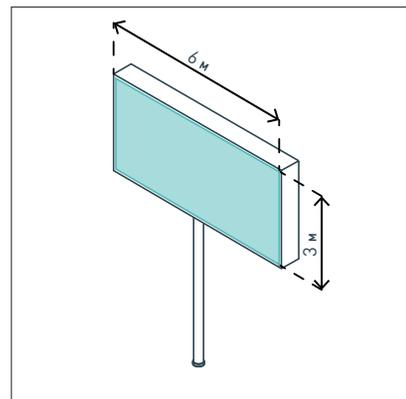
Размер информационного поля билбордов — 6×3 м. Не следует использовать выступающие элементы на крупноформатных конструкциях площадью больше 18 м<sup>2</sup>. Такая реклама может отвлечь водителя и создать опасную ситуацию на дороге.
