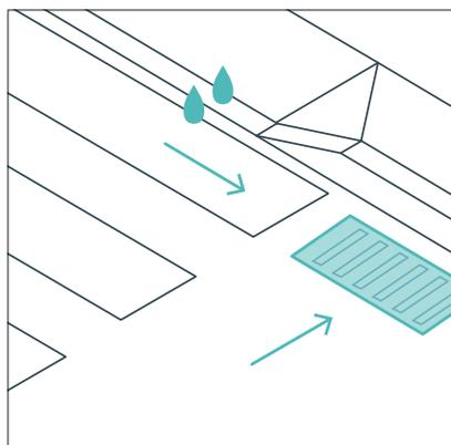
Дождеприемники следует размещать за пределами пешеходного перехода с уклоном в их сторону.
