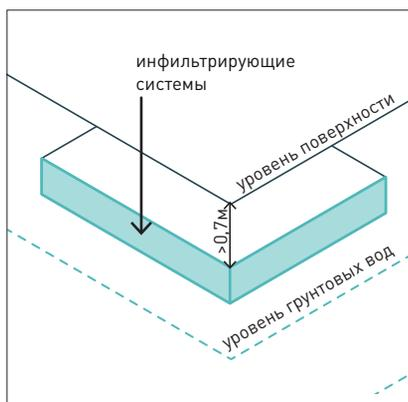
Инфильтрирующие системы следует заглублять  $\geq 0,7 \text{ м}$  от уровня поверхности, при этом размещать их выше уровня грунтовых вод.
