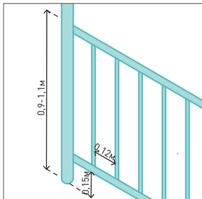
Высота — 0,9–1,1 м, шаг элементов заполнения секций  $\leq 0,12$  м для предотвращения прохода детей, животных. Высота нижней продольной перекладины  $\leq 0,15$  мм.
