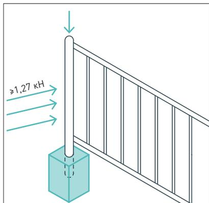
Стойки фундамента монтируются к фундаменту бетонированием для устойчивости к горизонтальным и вертикальным нагрузкам. Удерживающая способность  $\geq 1,27$  кН.
