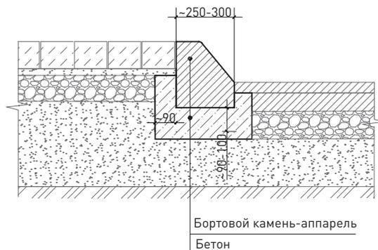
**33** Схема устройства сопряжения покрытий при помощи бортового камня стыковочного
