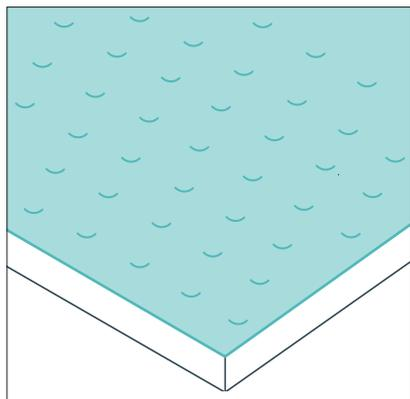
Рекомендуется использовать материалы с шероховатой, противоскользящей, не создающей вибраций поверхностью. Коэффициент сцепления: 0,6 — сухое,  $\geq 0,4$  — влажное.
