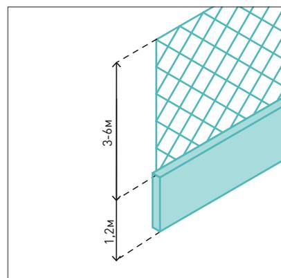
Высота сетчатых ограждений спортивных площадок — 3–6 м. Основание может быть выполнено в виде сплошной части высотой 1,2 м из травмобезопасных материалов (дерево, стеклопластик).
