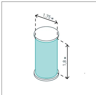
Размер информационного поля афишных стендов — 1,8×1,75 м.
