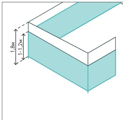
Рекомендуемая высота ограждения площадок для сбора ТБО — 1,8 м с нижней сплошной частью высотой 1–1,2 м для удобства промывки и дезинфекции.
