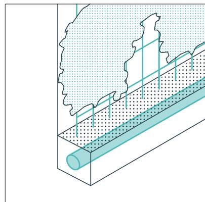
Посадочное место следует оборудовать перфорированной дренажной трубой, обернутой в геотекстиль, для отвода излишков влаги.
