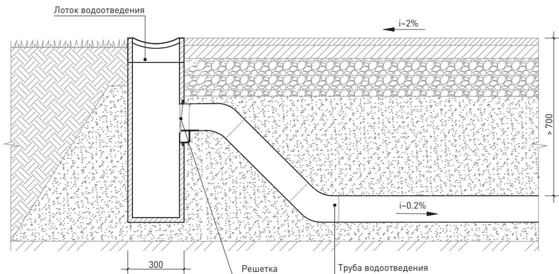
113 Схема устройства приемки подключения к подземным коммуникациям / сечение
