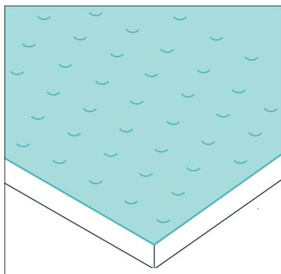
Поверхность — ровная шероховатая, противоскользящая, не создающая вибраций при движении. Коэффициент сцепления: 0,6 (сухое покрытие);  $\geq 0,4$  (влажное покрытие).
