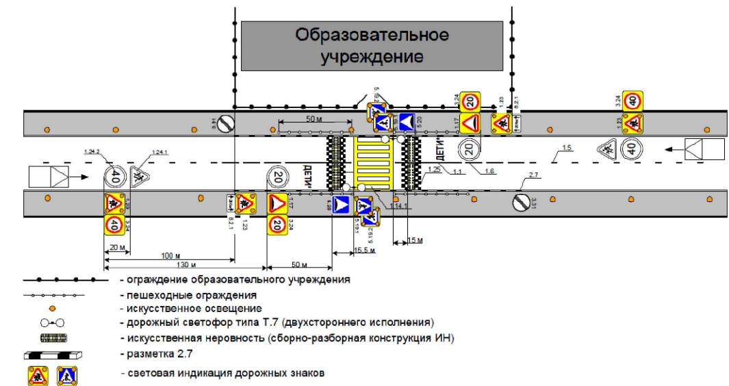
Типовая схема организации дорожного движения на нерегулируемом пешеходном переходе в непосредственной близости от образовательного учреждения при трехполосном движении транспортных средств.
